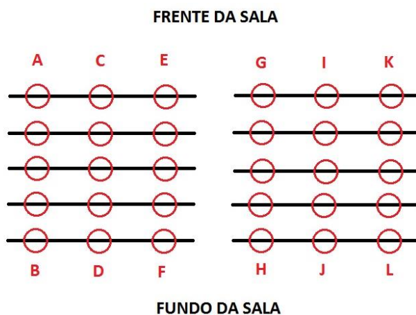
Figura 2: Arranjo experimental. As linhas pretas ilustram as fileiras das bancadas enquanto os círculos vermelhos indicam os computadores/microfones. As letras A-L indicam as posições onde os sons serão produzidos.
