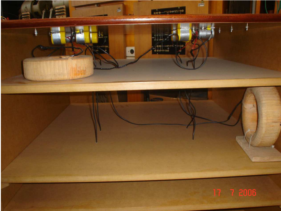
foto 02: linha de transmissão no mini sistema de potência
