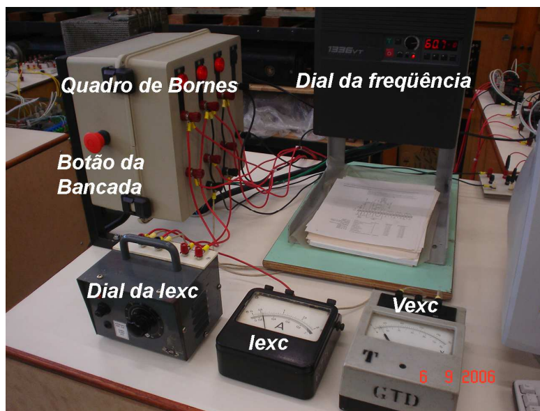
foto 04: dispositivos de controle de tensão e frequência.
