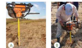
Figura 50 - (A) Aspecto de uma motocavadora e (B) abertura de burco com motocavadora.
