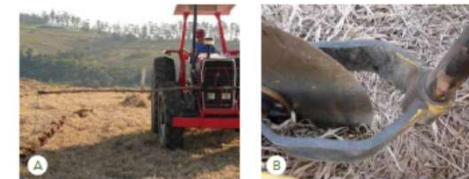
Figura 49 - (A) Uso de um cabo de madeira com uma corrente em sua extremidade para a orientação da subsolagem em relação à linha adjacente e (B) disco de corte do subsolador cortando a palhada já seca.
