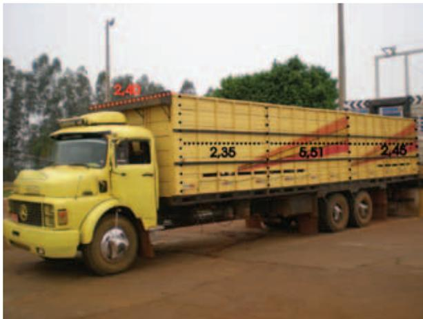
Para o caminhão da figura acima, por exemplo, que tem compartimentos de carga com as seguintes medidas: o primeiro (o mais próximo da cabine) com 2,35m de comprimento, o segundo (do meio) com 5,51m e o terceiro com 2,45m, os números ideais de animais (NA) com 500 kg de peso vivo a serem embarcados seriam:
