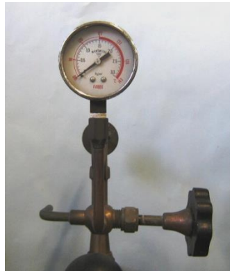
Válvula de exaustão e manômetro
