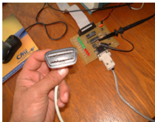
Figura 7.13-Detalhe do conector J1962
