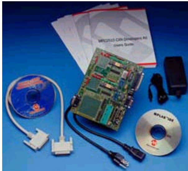
Figura 5.1-Kit de desenvolvimento CAN[ 9]
