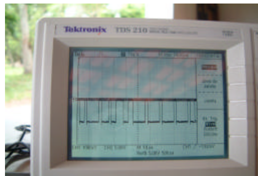
Figura 8.29 - Sinal do barramento CAN
