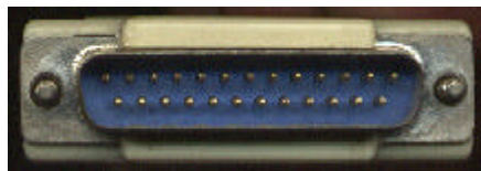
Figura 6.1-Foto do conector DB25 macho
