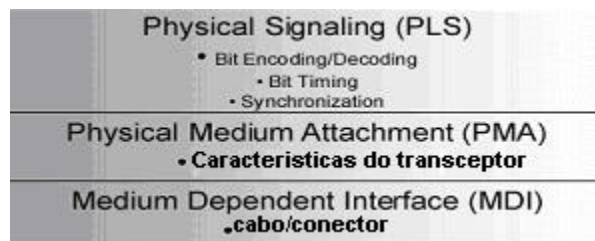
Figura 3.17-As três subcamadas físicas[ 13]
