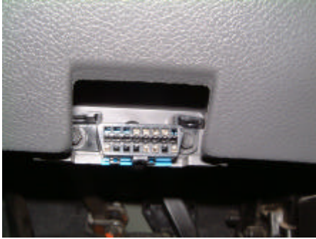
Figura 8.22 Detalhe do conector OBDII/J1962 no Fiesta
