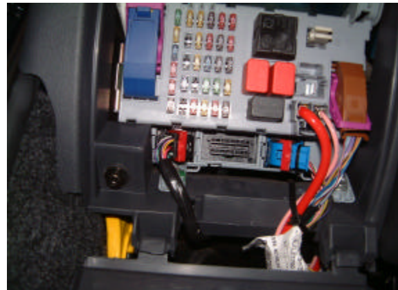
Figura 8.12-Detalhe do painel e localização do OBDII
