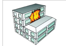
Figura 5: Propagação entre duas edificações geminadas com alturas diferenciadas
