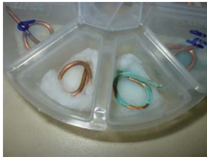
Figura 4: Amostras de cobre após uma semana de ensaio. Na direita, tem-se o produto 15 e, na esquerda, o produto 16.
