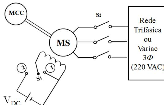
Figura 1: Procedimento para a partida da máquina síncrona como motor. No primeiro estágio, o motor síncrono é alimentado com 220 V<sub>AC</sub>, e o circuito de campo em curto circuito. No segundo estágio, verifica-se se a velocidade está próxima da velocidade síncrona para eliminar o curto circuito e aplicar corrente contínua no campo.
