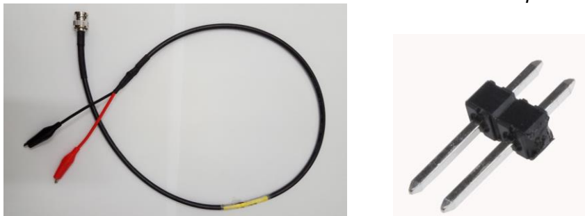
Figura 3 – Cabo coaxial com terminais BNC – jacarés e pinos para medição de v id (t).
