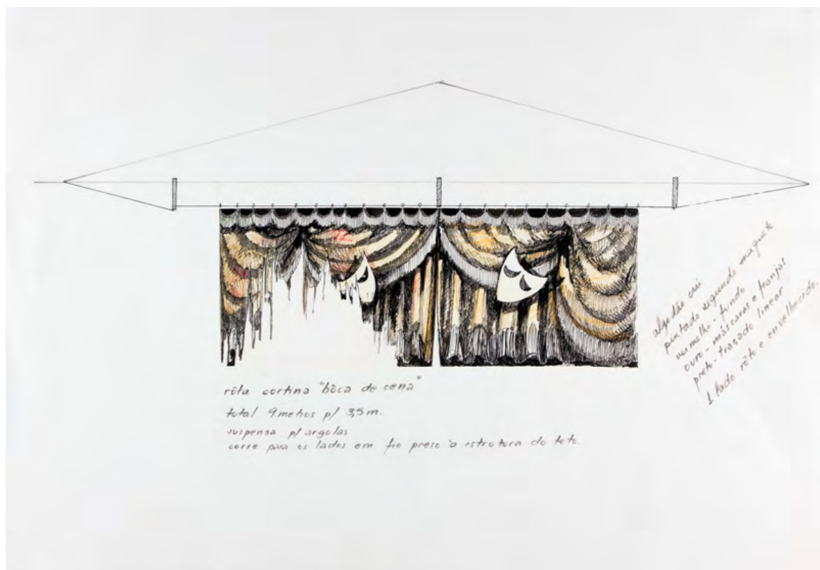
Figura 55 – Projeto para cortina, onde lê-se “rota cortina ‘boca de cena’/ total 9 metros p/ 3,5m/ suspensa p/ argolas/ corre para os lados em fio preso à estrutura do teto” e “algodão cru/ pintado seguindo a maquete/ vermelho – fundo/ ouro – máscaras e franjas/ preto – traçado linear/ um lado roto e envelhecido”. Acervo Flávio Império.
