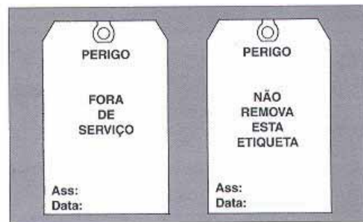
Figura 55a. Frente e verso de uma etiqueta típica usada quando o equipamento é posto fora de serviço devido a ter se tornado pouco seguro.
