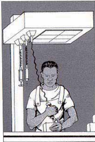
Figura 24c. Providencie uma estrutura especial que fique acima do trabalhador, na qual possam ser suspensas as ferramentas por meio de mecanismos de molas ou elásticos.
