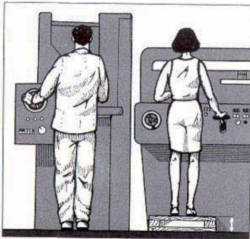
Figura 58a. Utilize plataformas sob os pés para os trabalhadores mais baixos com o objetivo de assegurar uma altura de trabalho apropriada, próximo ao nível dos cotovelos.
