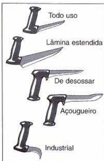
Figura 22a. As ferramentas fabricadas para usos específicos diferentes podem funcionar melhor que as para uso geral.
