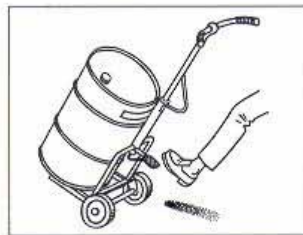
Figura 6d. Este dispositivo para manipular barris não apenas facilita muito o trabalho como também ajuda a prevenir danos.
