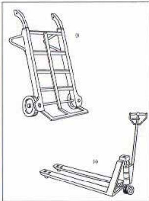
Figura 6a. (i) Um carrinho de mão para sacos pesados e (ii) uma transpaleteira são meios confiáveis, seguros e fáceis de manejar. Permitem o transporte de cargas pesadas em curtas distâncias, com uma elevação mínima.
