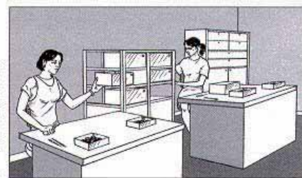
Figura 5a. Providencie armários metálicos ou estantes para armazenagem, de forma que os elementos de trabalho provenientes de um posto de trabalho possam passar diretamente ao seguinte.
