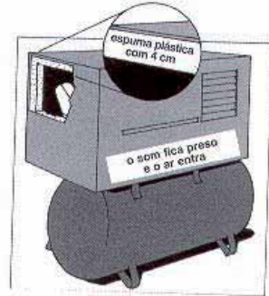
Figura 88c. Uma espessura de chapa de 1,5 mm reduz as vibrações.
