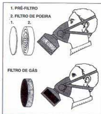
Figura 102a. Três tipos de máscaras com filtro. No alto, à esquerda: Como proteção contra partículas conduzidas pelo ar, como, por exemplo, pó de pedra. Abaixo, à esquerda: Como proteção contra gases e fumaças, como, por exemplo, no uso de tintas que contêm solventes. Este filtro contém carbono ativado. Acima: Com um filtro combinado contendo tanto filtro de poeira como de gás. Essas máscaras são exemplos da proteção respiratória eficaz mais simples. Substitua o filtro quando a respiração se tornar difícil ou quando começar a exalar odor. Faça-o com frequência.
