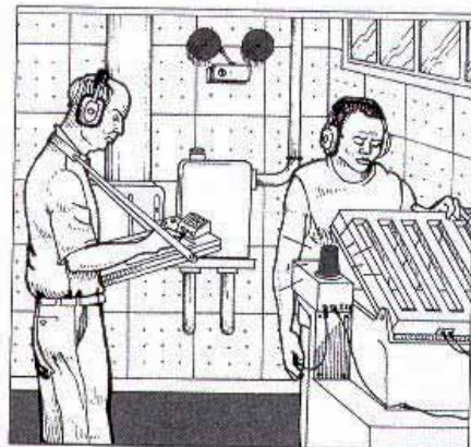
Figura 90b. Certifique-se de que os protetores de ruídos sejam eficazes mas não impeçam a comunicação necessária. Sinais luminosos de emergência e alarmes são meios importantes de comunicação quando um protetor de ouvido está sendo utilizado.
