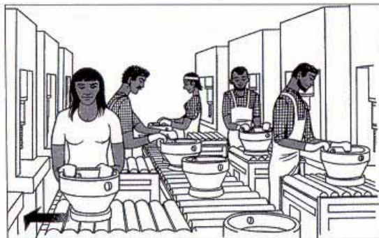
Figura 6b. Uma esteira transportadora passiva para mover peças pesadas de motores em elevações de trabalho.
