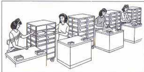
Figura 120a. Linha de montagem com estoques intermediários.
