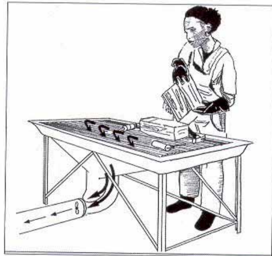
Figura 94b. Aspirar os resíduos contaminados da superfície de trabalho antes que possam atingir a área de respiração do trabalhador é um outro método de realizar ventilação local.
