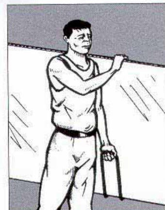
Figura 16c. Pontos onde segurar, adaptados ao próprio objeto transportado, podem facilitar a tarefa de transporte.
