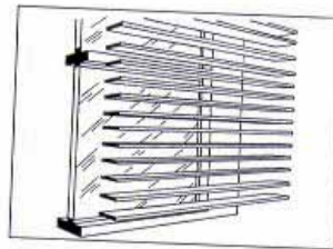
Figura 83b. As persianas externas de lâminas de madeira proporcionam proteção contra a radiação solar durante todo o dia.
