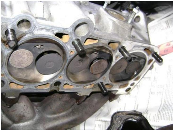
Figura 7 – Sistema de válvulas no cabeçote.
