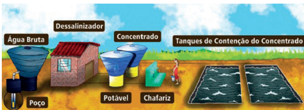
Figura 1. Desenho do sistema de dessalinização adotado pelo Programa Água Doce
