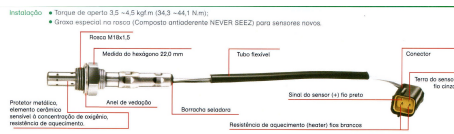
Figura 7.3: Esquema de ligação externo.
