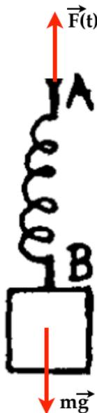
Perceba que ao incluir a mola como parte do novo sistema físico, a força  $\vec{F}_k$  aplicada pela mola no bloco (no ponto  $B$ ) passa a ser uma força interna ao sistema. Essa força deve ser cancelada pela reação do bloco na mola, também interna.
