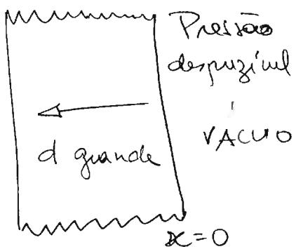
Em  $t=0$ , uma das faces da parede é exposta ao "vácuo"
