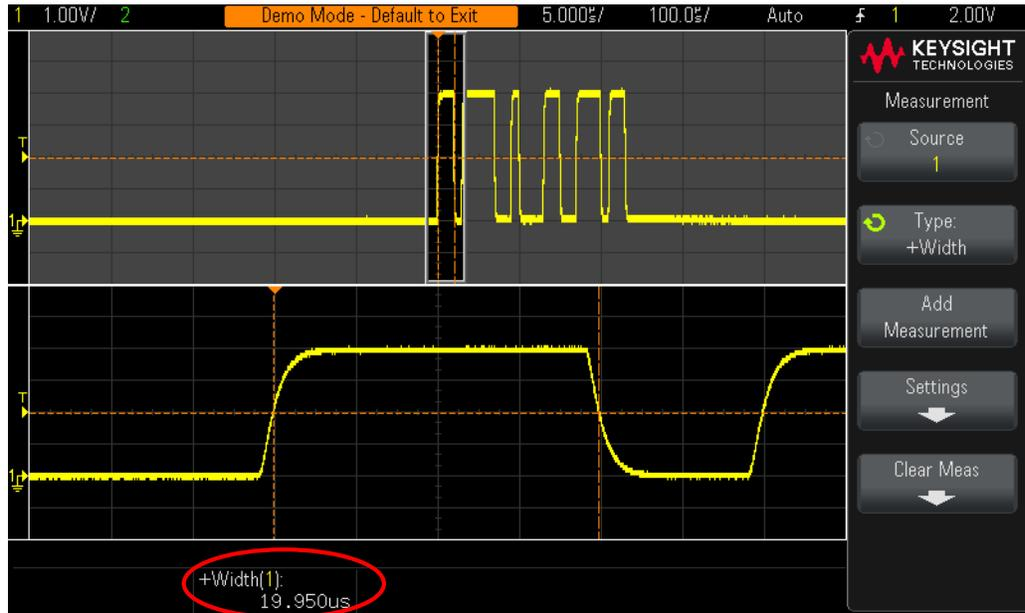
**Figure 38** Usando o modo de base de tempo do Zoom do osciloscópio para executar medições "controladas"
