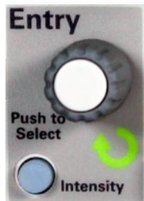
Figure 7 Controle de entrada geral do osciloscópio
