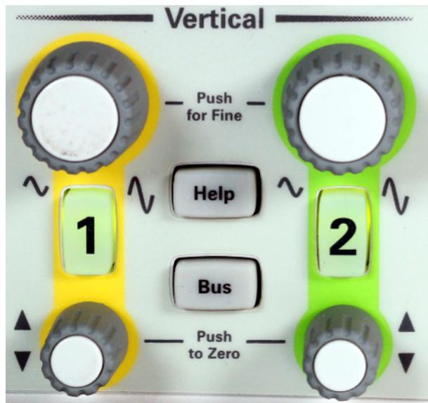
**Figure 5** Controles verticais do osciloscópio (eixo Y)
