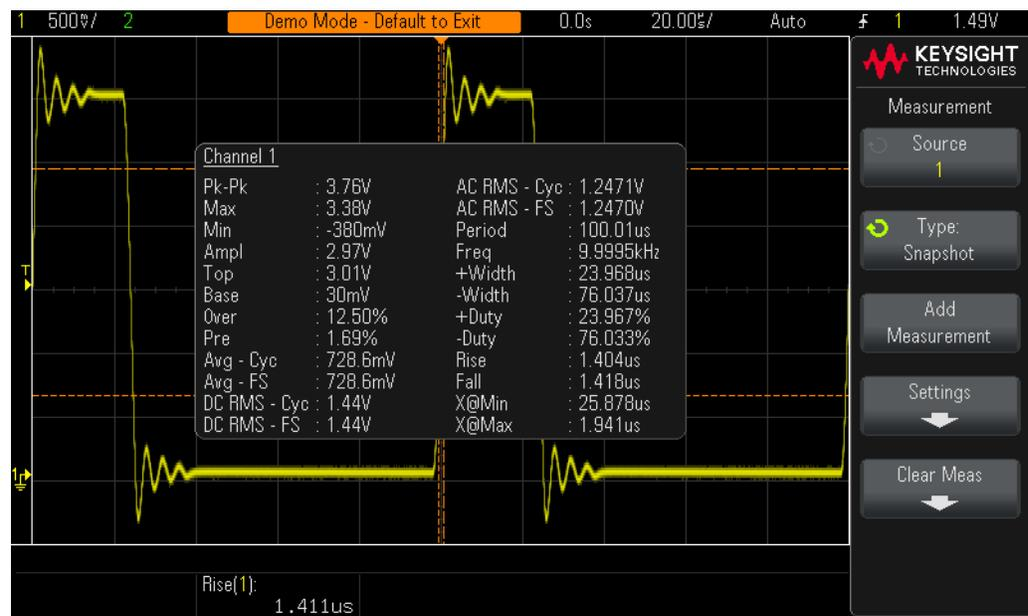
**Figure 35** Executando um conjunto abrangente de medições paramétricas automáticas usando a função “Instantâneo de todas”.
