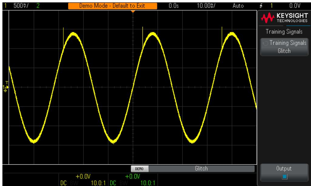
**Figure 40** A taxa de amostragem reduzida automaticamente pelo osciloscópio faz uma subamostragem da variação rápida repetitiva
