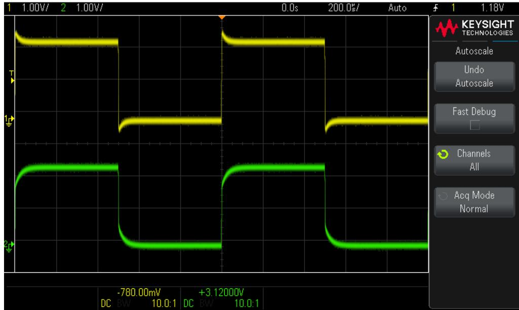
**Figure 22** Pontas de prova compensadas incorretamente
