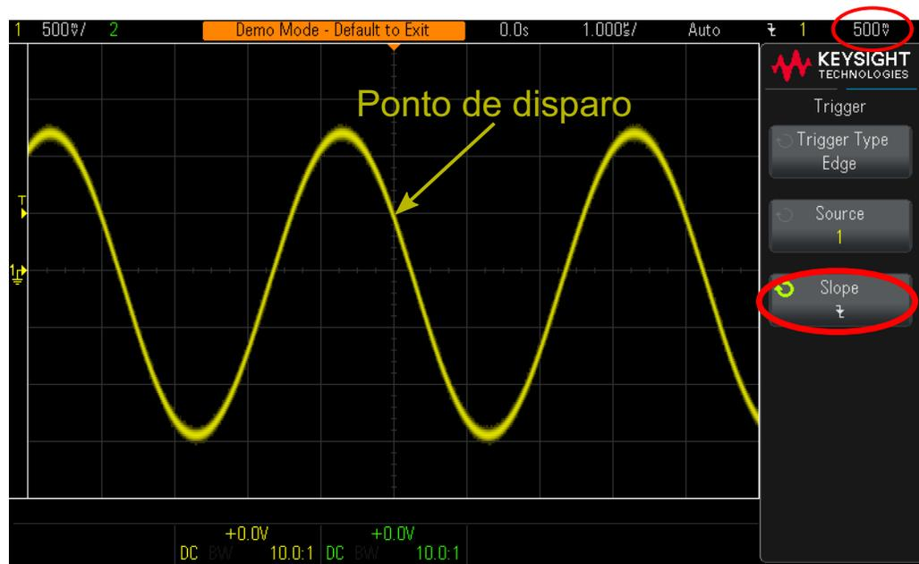
**Figure 13** Disparo na borda descendente da onda senoidal a + 500 mV
