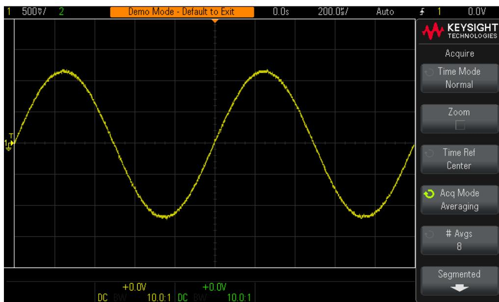
**Figure 17** Usar o modo de aquisição Média do osciloscópio para eliminar o ruído
