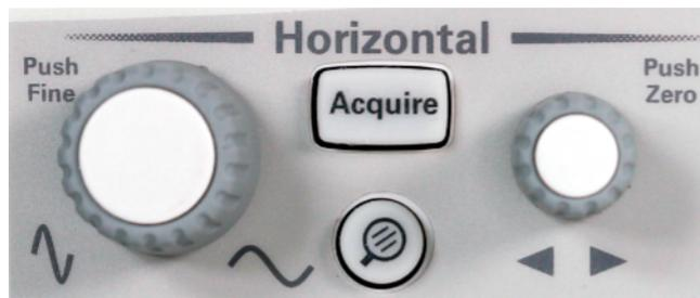
**Figure 4** Controles horizontais do osciloscópio (eixo X)
