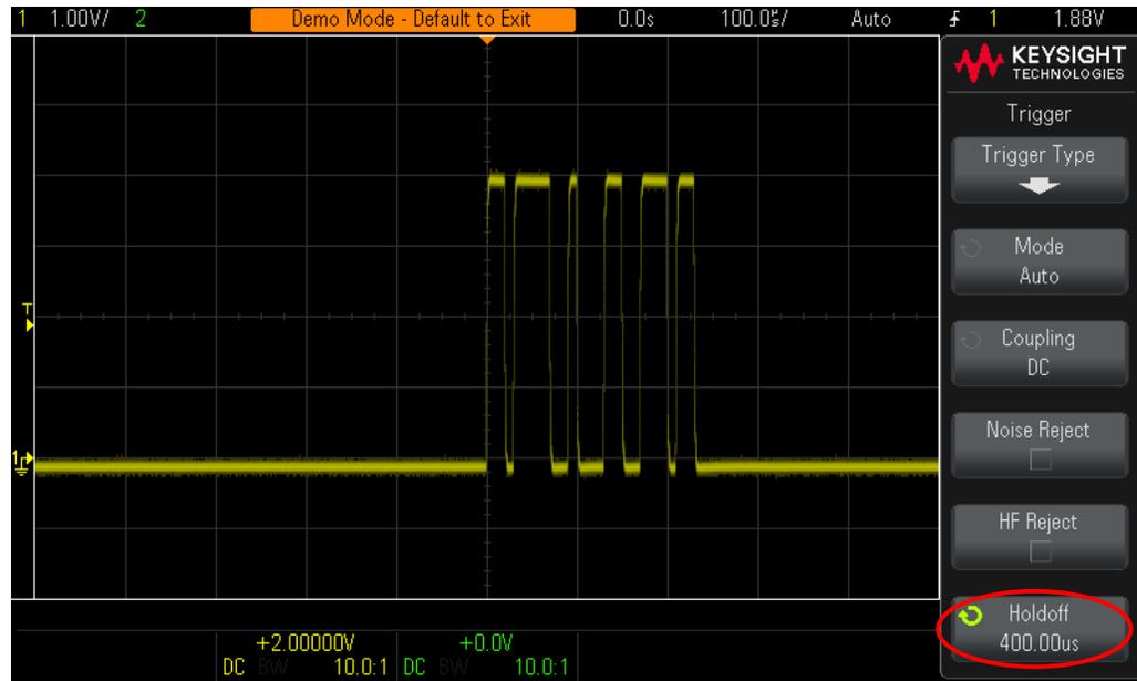
**Figure 36** Configurando o osciloscópio para capturar uma rajada de pulsos digitais com larguras de pulso diferentes
