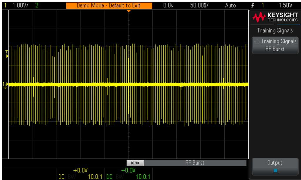
**Figure 43** Capturando as várias formas de onda de rajadas RF usando uma configuração de tempo de base mais lenta
