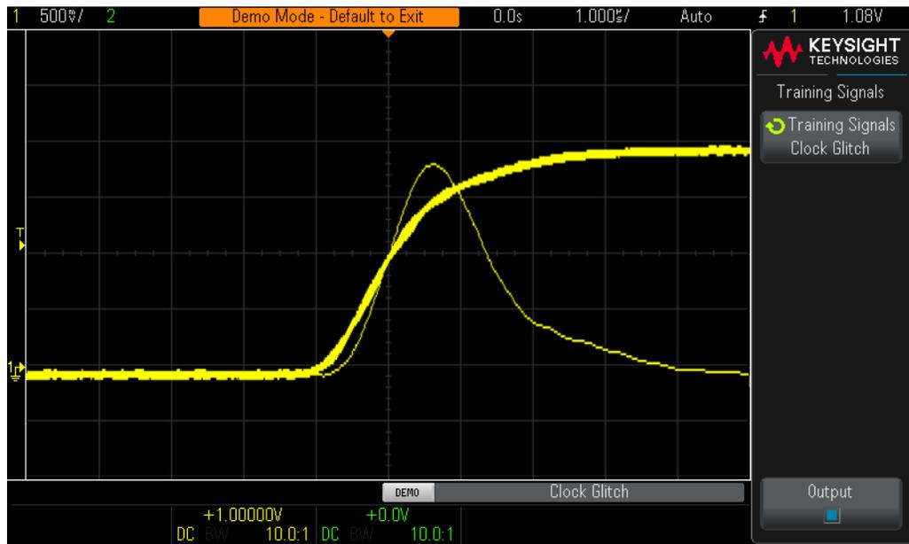
**Figure 28** A taxa de atualização de forma de onda rápida do osciloscópio captura uma variação rápida infrequente
