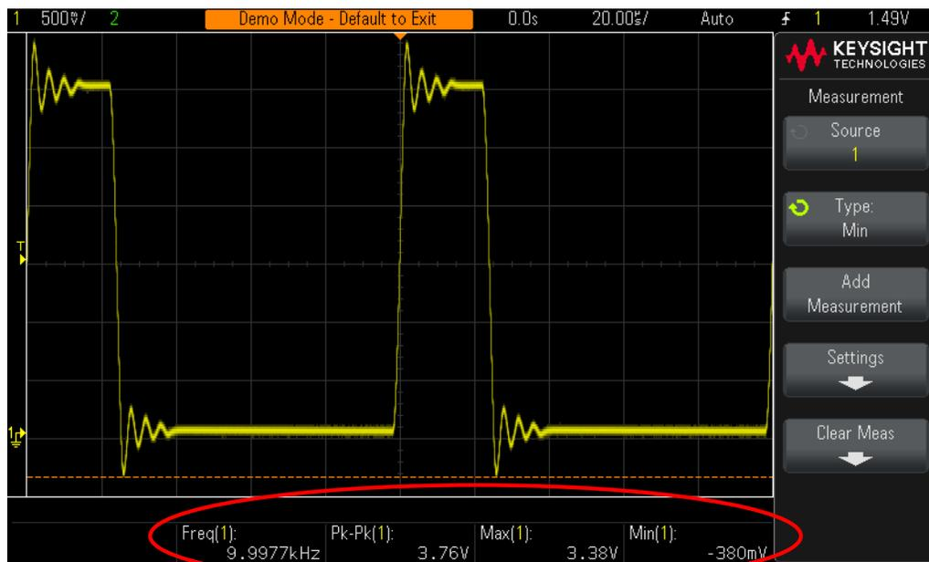
**Figure 32** O osciloscópio executa automaticamente até quatro medições paramétricas
