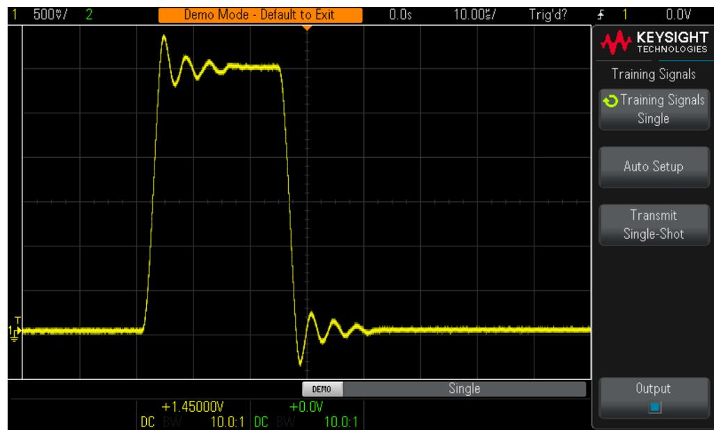
**Figure 30** Configurar o osciloscópio para capturar um evento único
