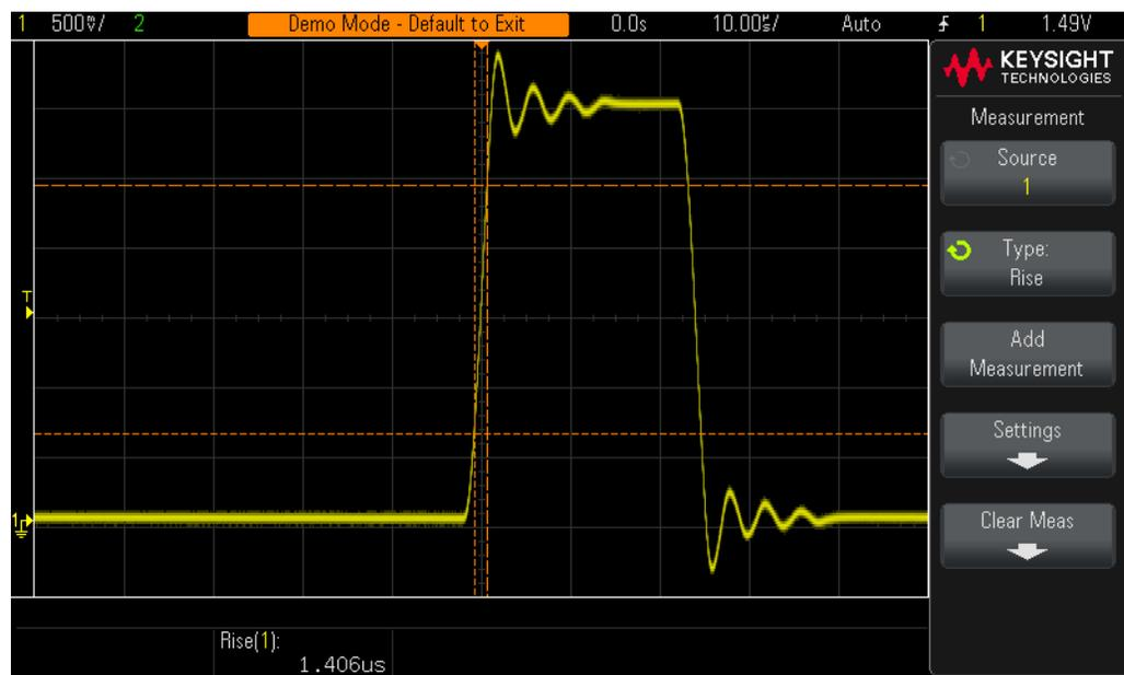
**Figure 34** Executando uma medição de tempo de subida relativa aos níveis de limite de 20% e 80%
