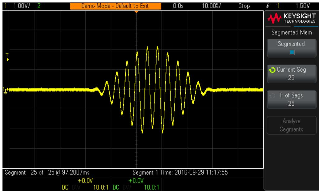
**Figure 45** Usando a aquisição de memória segmentada para capturar mais formas de onda com alta resolução
