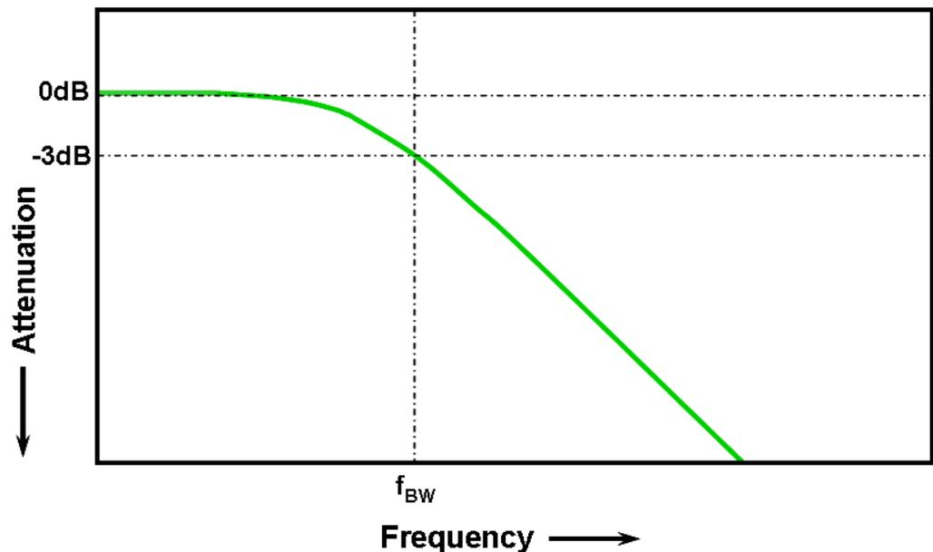
**Figure 47** Resposta de frequência gaussiana do osciloscópio
