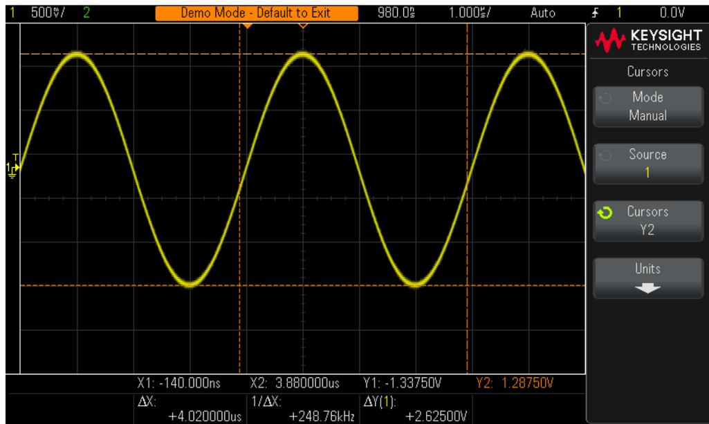
**Figure 11** Usar as medições de cursor do osciloscópio
