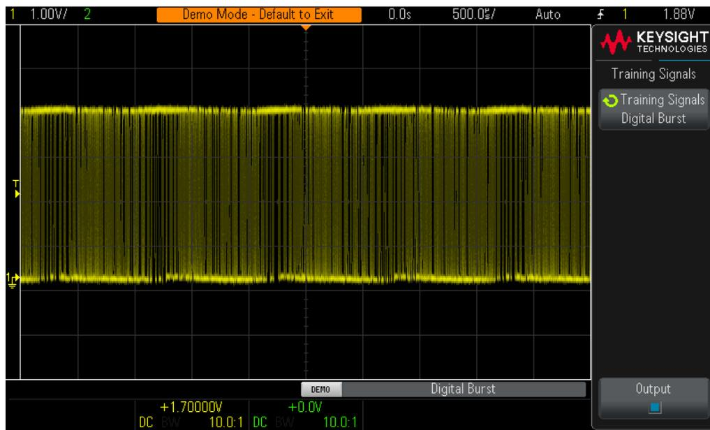
**Figure 25** Tentativa de observar uma rajada de pulsos durante o uso das condições de configuração padrão de disparo do osciloscópio
