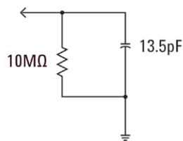
**Figure 23** Modelo de carregamento do osciloscópio e da ponta de prova passiva 10:1
