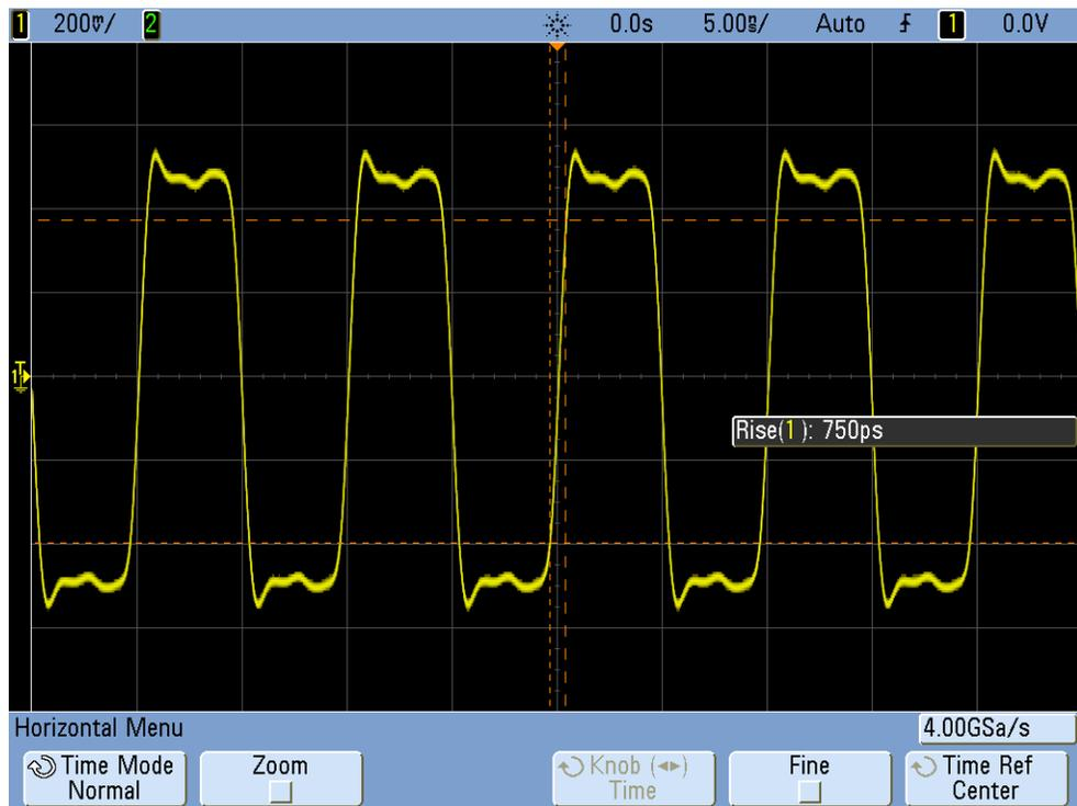
**Figure 50** Sinal de relógio digital de 100 MHz captado em um osciloscópio com largura de banda de 500 MHz
