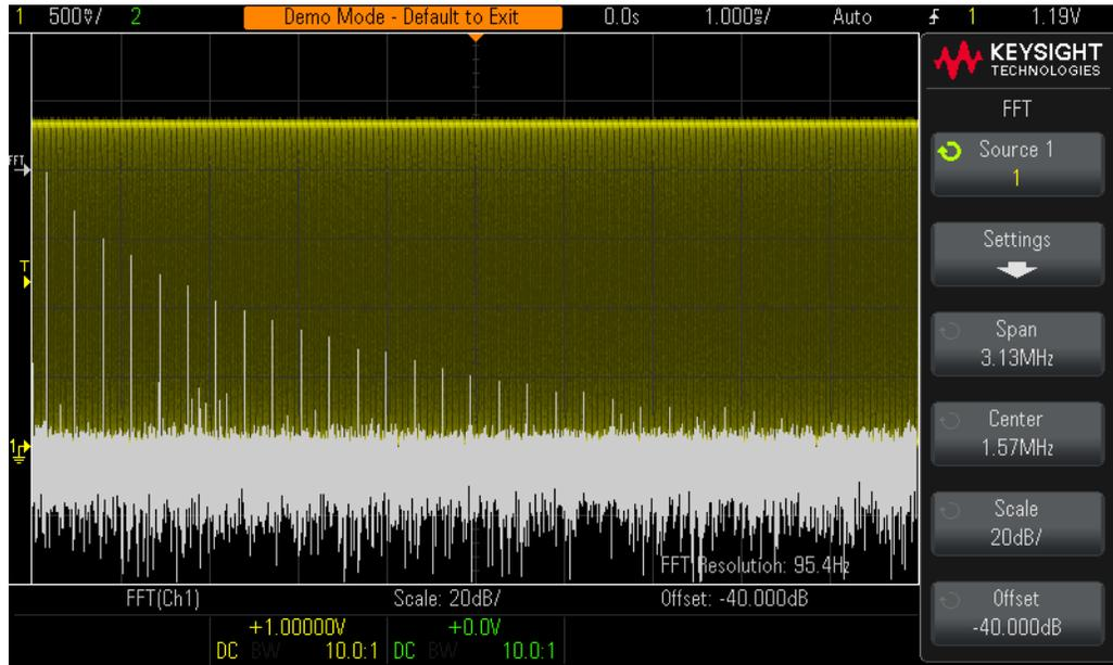
**Figure 39** Executando uma função matemática FFT em um relógio digital repetitivo
