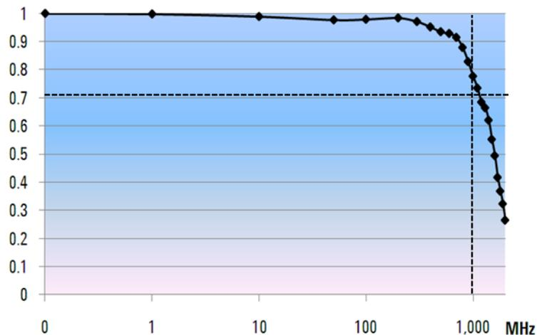
**Figure 48** Resposta de frequência real de um osciloscópio Keysight com largura de banda de 1 GHz
