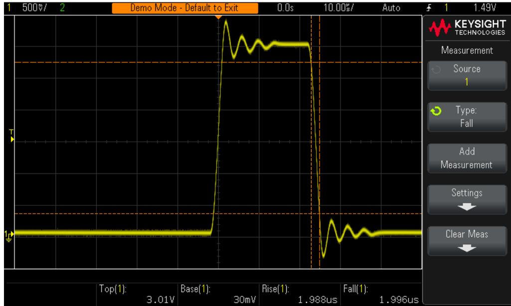
**Figure 33** Executando medições de parâmetros de pulso adicionais em um pulso digital
