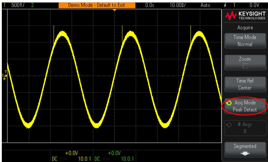
**Figure 41** O modo de aquisição Detecção de pico captura, confiavelmente, as variações rápidas estreitas na onda senoidal lenta
