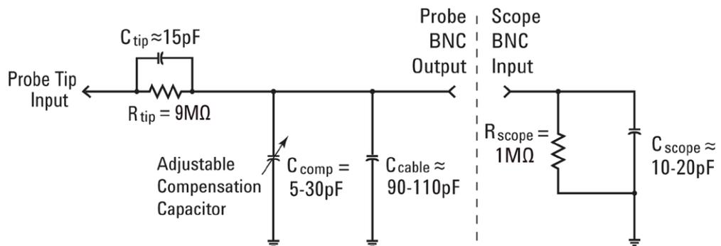
**Figure 20** Esquema simplificado de uma ponta de prova 10:1 passiva conectada à impedância de entrada de  $1 M\Omega$  do osciloscópio
