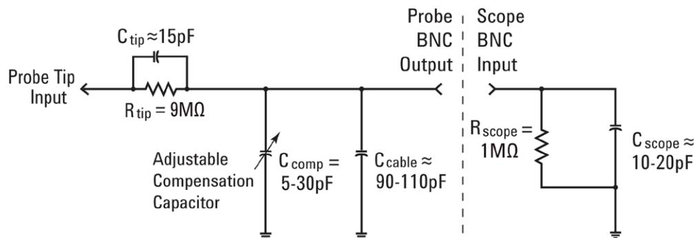
**Figure 3** Esquema simplificado de uma ponta de prova 10:1 passiva conectada à impedância de entrada de  $1\text{ M}\Omega$  do osciloscópio
