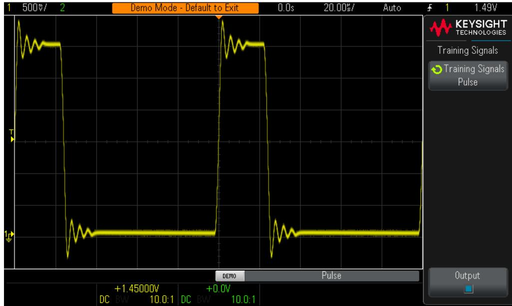
**Figure 31** Configuração do osciloscópio para capturar e mostrar um pulso digital repetitivo com oscilação e overshoot
