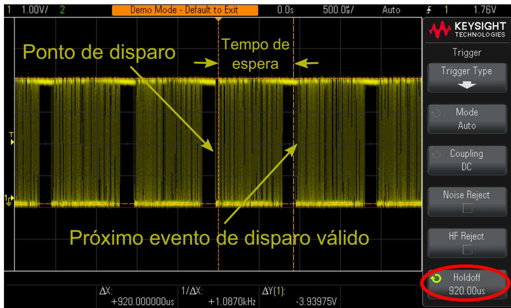
**Figure 27** Usando o recurso de espera de disparo do osciloscópio para sincronizar com uma rajada de pulsos
