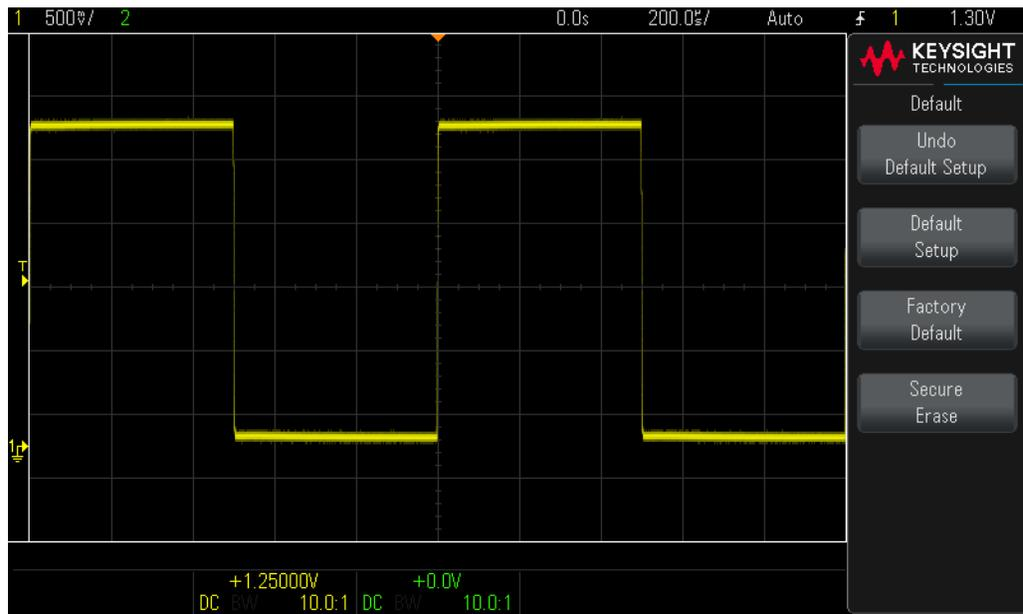
**Figure 21** Usar o sinal de compensação da ponta de prova de 1 kHz do osciloscópio para compensar pontas de prova passivas de 10:1
