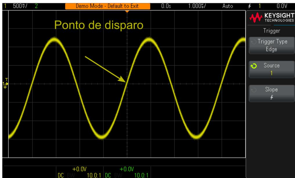
**Figure 12** Disparar o osciloscópio em uma borda ascendente do canal 1 a 0,0 volts
