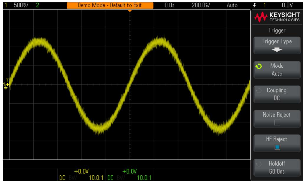
**Figure 16** Disparar em uma onda senoidal com ruído usando o HF Reject
