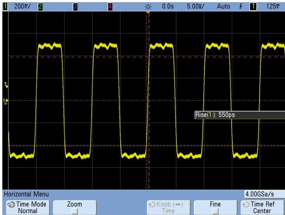
**Figure 51** Sinal de relógio digital de 100 MHz captado em um osciloscópio com largura de banda de 1 GHz
