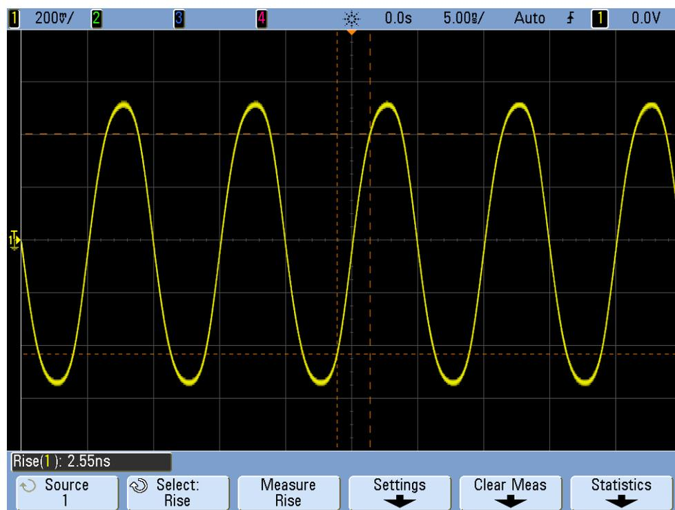
**Figure 49** Sinal de relógio digital de 100 MHz captado em um osciloscópio com largura de banda de 100 MHz
