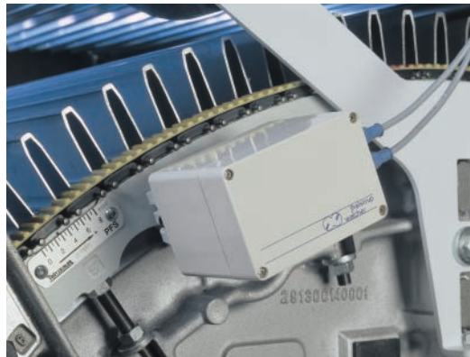
Este servomotor ajusta a distância dos flats ao tambor
