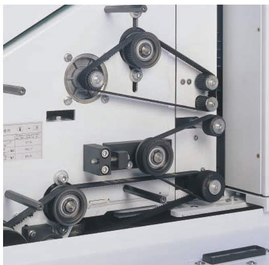
Servo-acionamentos digitais para alta dinâmica de regulação
