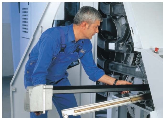
A montagem do sensor de neps tornou-se ainda mais simples com o novo guia telescópico
