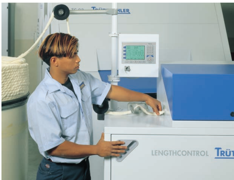
O operador precisa colocar somente a fita. A medição transcorre automaticamente
