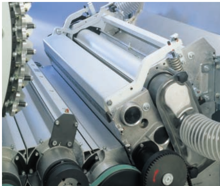
Cuba integradora SENSOFEED para fixação perfeita e regulação precisa de períodos curtos
