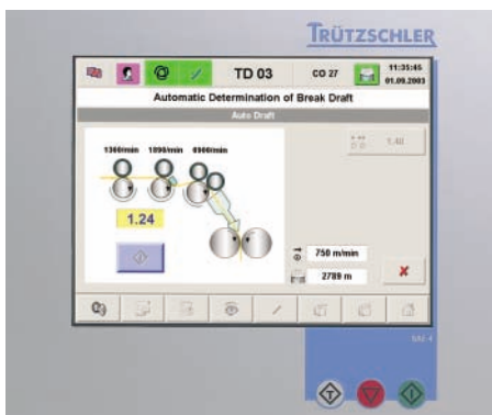
Auto-ajuste da pré-estiragem com AUTO DRAFT
