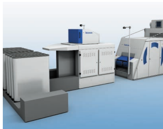
O passador integrado com trocador automático de latas retangulares
