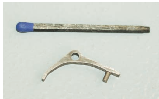
A comparação com um palito de fósforo mostra: a massa da alavanca de medição foi reduzida a um mínimo, para assegurar uma alta frequência de medição
