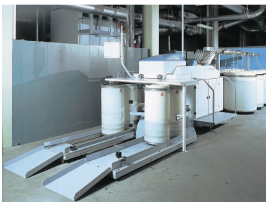
Trocador de latas autônomo sem ligação mecânica com o passador
