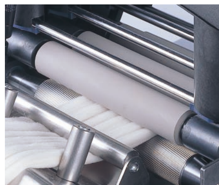
Nova carga dos cilindros superiores com AUTO RELEASE em paradas
