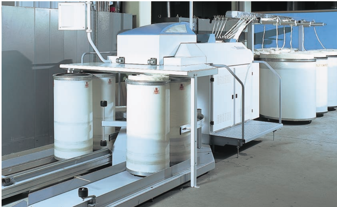
O trocador automático de latas do passador TD 03 é padrão para todos formatos de latas
