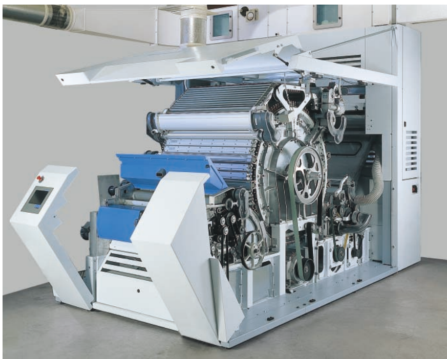
As portas podem ser retiradas totalmente e todas as áreas da carda são livremente acessíveis
