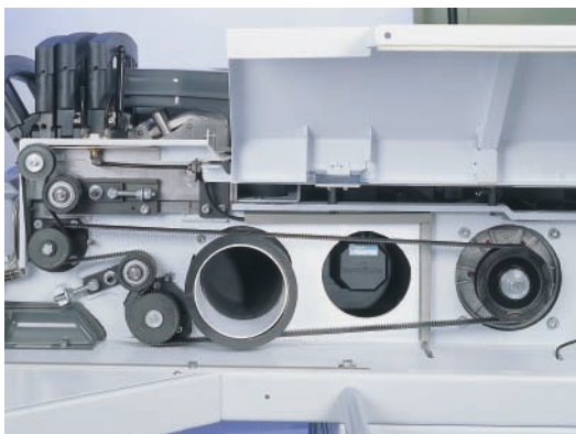
Acionamentos diretos para mais alta dinâmica de regulação
