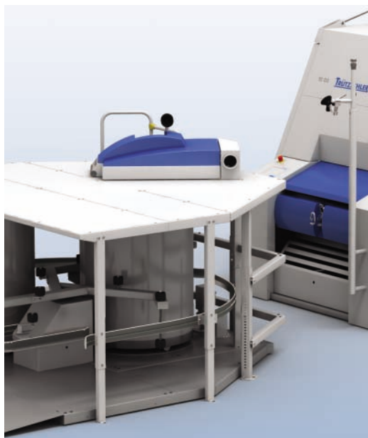
O novo trocador de latas, com acionamento independente, está disposto livremente diante da carda e sem ligação mecânica
