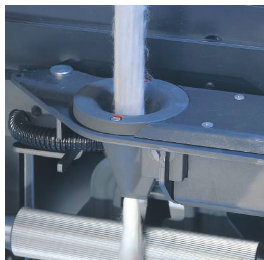
Sensor de qualidade para o controle da fita antes do depósito na lata
