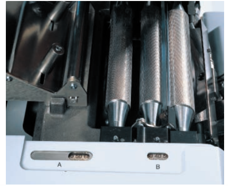
Ajuste automático rápido e preciso da largura da área de estiragem
