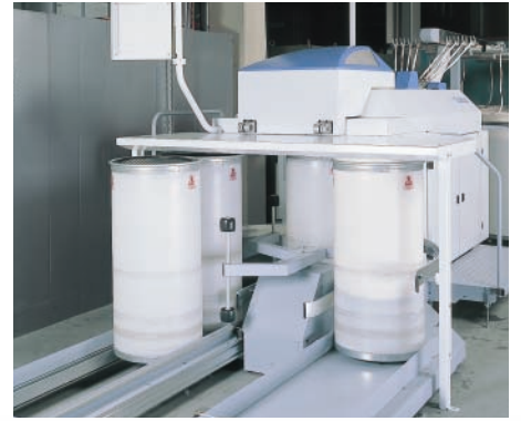
Trocador automático de latas redondas ou retangulares, opcional
