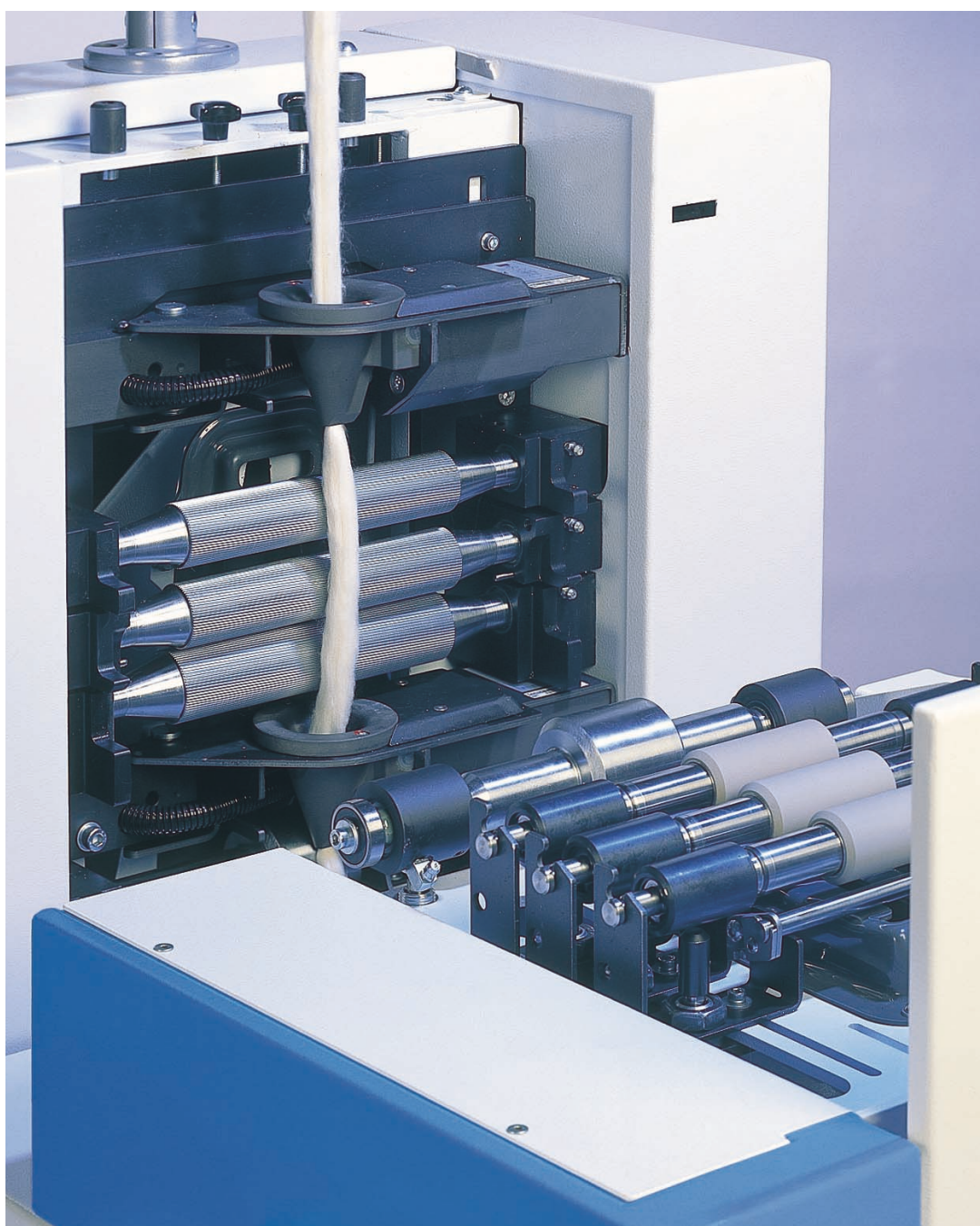
O conjunto de estiragem regulador aberto
