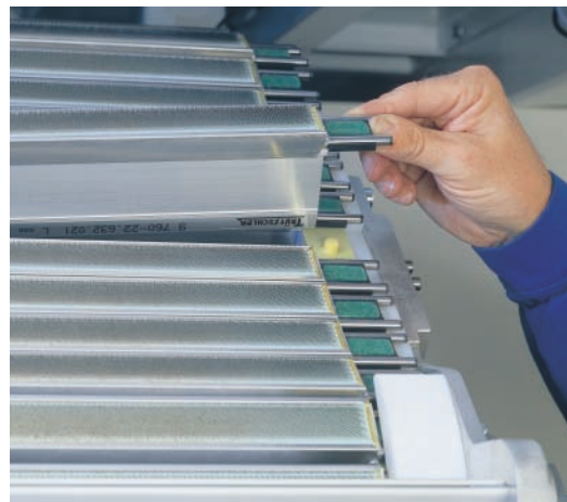
As hastes de flats podem ser encaixadas nos pinos da correia dentada sem ferramenta
