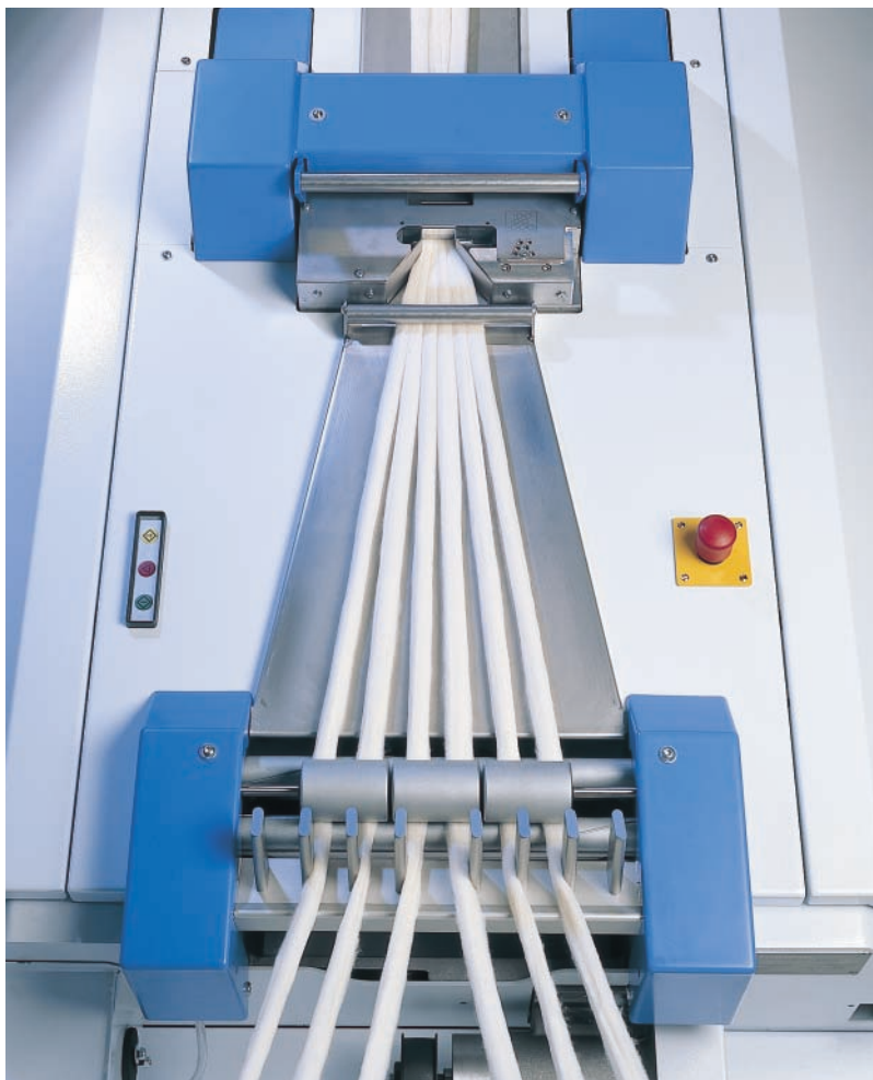
Um sensor de entrada confiável registra a massa de todas as fitas na entrada
