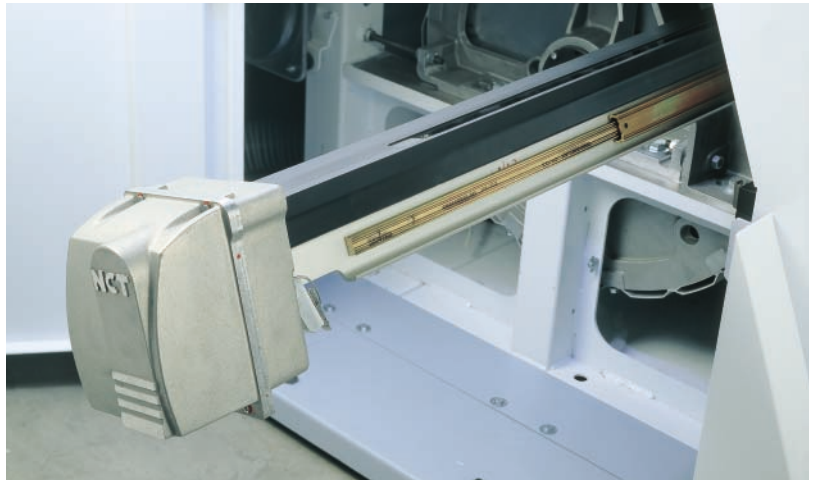
O sensor de neps é montado na carda, de forma simples, através de um guia telescópico
