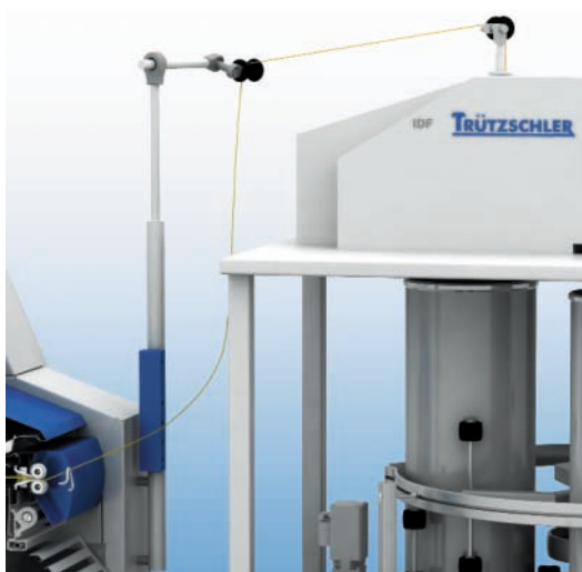
Barreira de luz para sincronização automática da velocidade de entrega com a carda através de regulação da catenária da fita entre as máquinas
