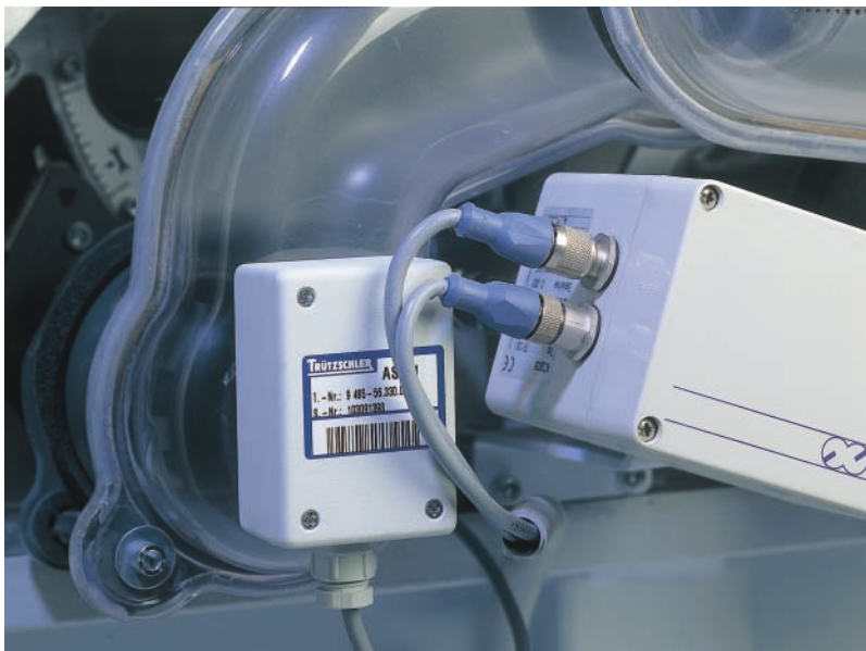
O sensor, montado na aspiração abaixo do primeiro cilindro pré-abertura do WEBCLEAN
