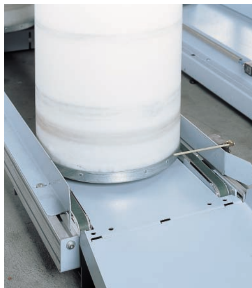
A entrada de latas com acionamento positivo comprovado proporciona o transporte de latas controlado
