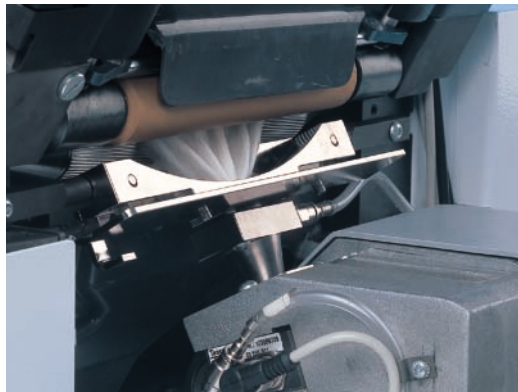
Colocação pneumática da fita
