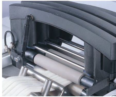
Supervisão de embuchamento auto-ajustável está integrado ao suporte do cilindro superior
