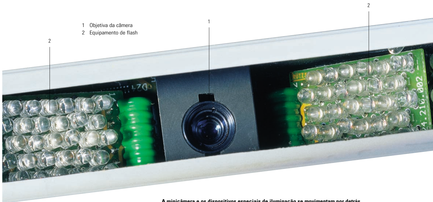
A minicâmera e os dispositivos especiais de iluminação se movimentam por detrás do vidro e fotografa o véu
