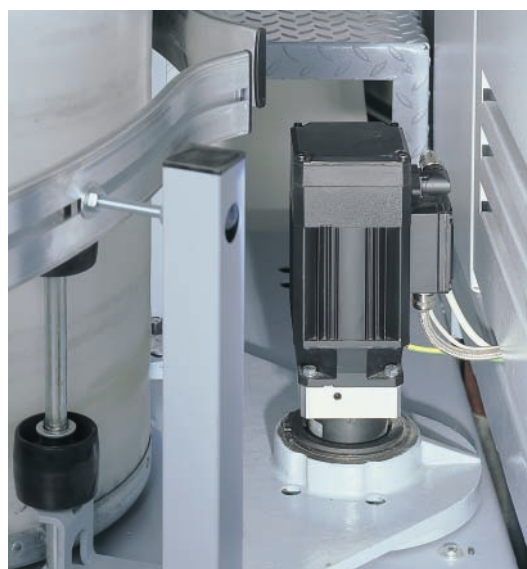
Acionamento adicional para ajuste linear da geometria do depósito
