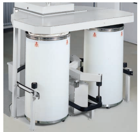
Trocador de latas de 400 a 1000 mm de diâmetro
