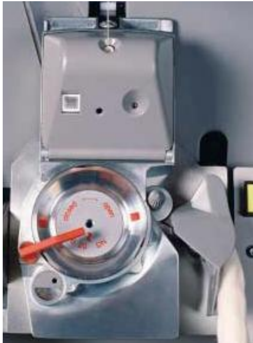
Unidade de fiação a rotor da Rieter
