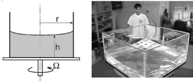
**Dicas:** Adote um sistema de coordenadas cilíndrico. Escreva apenas o balanço entre o gradiente de pressão radial e a força centrífuga. Integre dos dois lados para obter  $h(r)$ . Deixe a constante  $h_0$  indicada.
