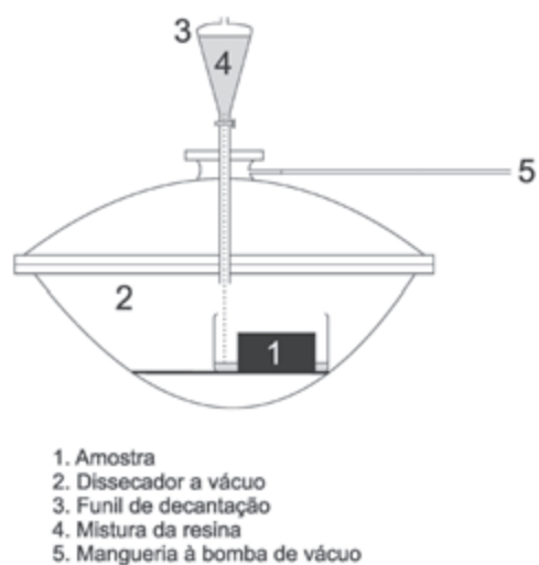
Fig. 3. Esquema de impregnação no laboratório de amostras de solos e sedimentos para micromorfologia, adaptado de Courty et al. (1989:59).
