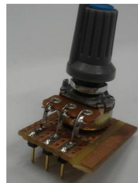
Figura 02 – Simbologia e imagem do potenciômetro de 10 k $\Omega$  adaptado para o experimento.
