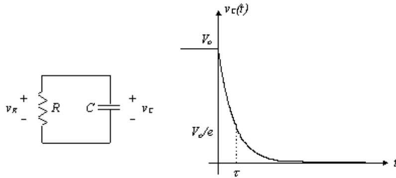
**Figura 2 – Curva de tensão do capacitor - resposta natural.**
