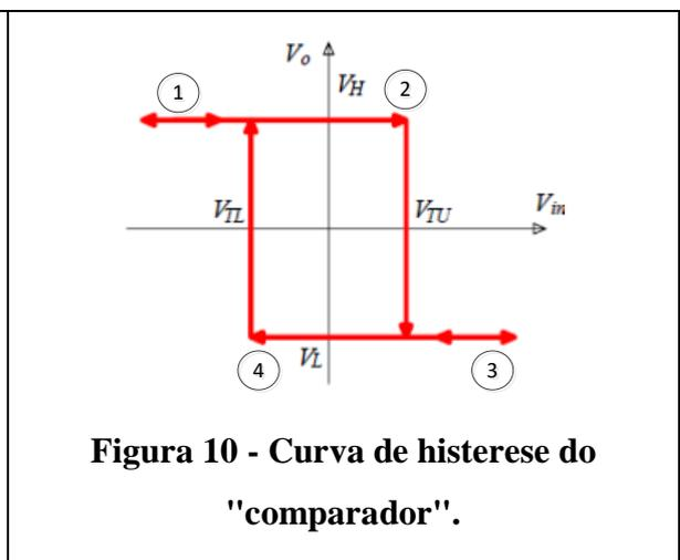
Vamos analisar o comportamento do circuito (**Fig. 9**) passo-a-passo, supondo inicialmente que o nível de saída encontra-se em  $V_0 = V_H$ .
