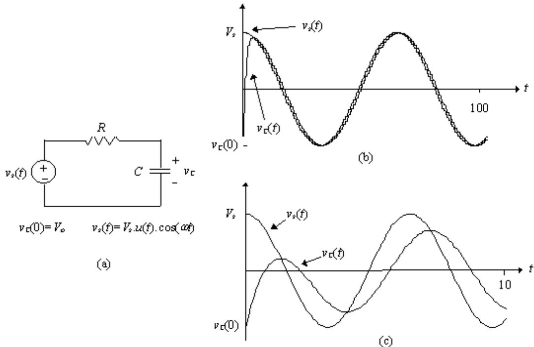
**Figura 8 – Respostas forçada senoidal do circuito RC.**
