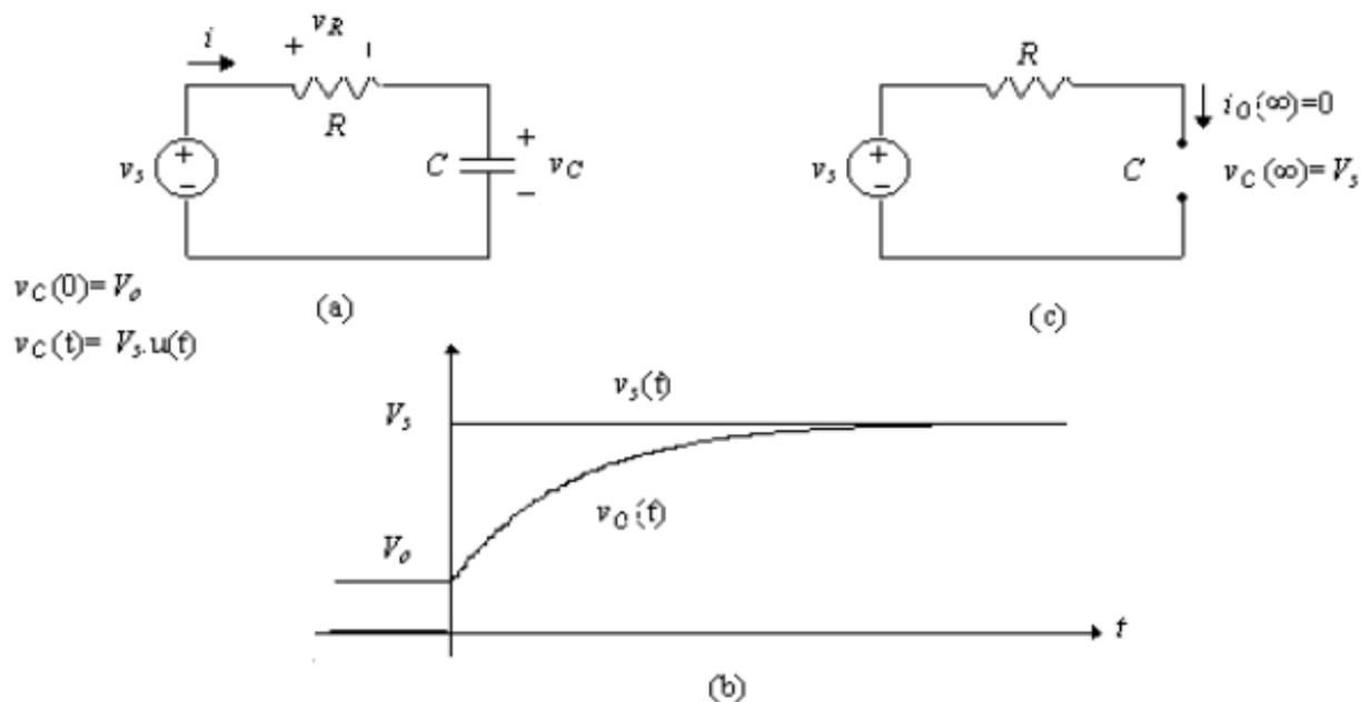
**Figura 5 – Solução forçada (degrau) do circuito RC.**
