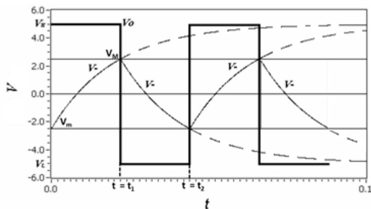
**Figura 12** Gráfico da tensão sobre o capacitor e da saída do oscilador.
