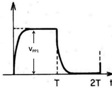
**Figura 7 – Tensão de saída no capacitor quando excitado com uma onda quadrada de baixa frequência ( $1/T \ll 1/\tau$ )**
