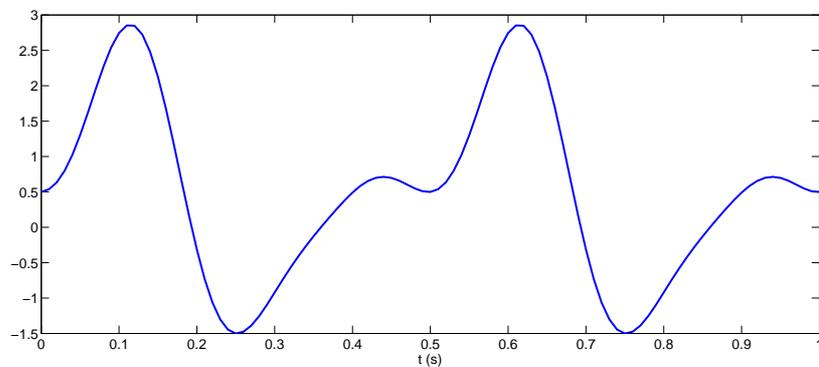
Figura 4: Exemplo:  $s(t)$  obtido a partir de (3) usando  $a_0 = 0,5$ ,  $a_1 = 1$ ,  $a_2 = -1$ ,  $b_1 = 1$ ,  $b_3 = -0,3$  e todos os outros coeficientes iguais a zero.
