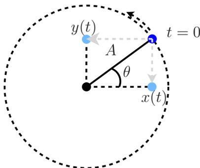
Figura 2: Seno e co-seno como projeções nos eixos  $x$  e  $y$  da posição de um objeto em movimento circular. Se a velocidade do objeto é constante, e o objeto faz uma revolução a cada  $T$  segundos, vale  $x(t) = A \cos\left(\frac{2\pi}{T}t + \theta\right)$ . Note que  $\omega_0 = 2\pi/T$ .
