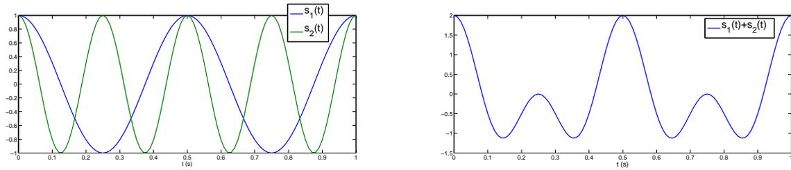
Figura 3: Senóides harmônicas. À esquerda, sinais  $c_1(t)$  e  $c_2(t)$ . À direita, sinal  $c_1(t) + c_2(t)$ . Note que o período da soma é igual ao período de  $c_1(t)$ .
