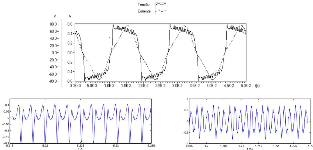
Figura 1: Exemplos de sinais periódicos: Acima: sinais de tensão e corrente em uma lâmpada fluorescente. Abaixo, à esquerda: nota “mi” tocada em um clarinete. Abaixo, à direita: trecho de voz (vogal “O”).
