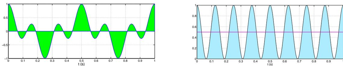
Figura 5: Produtos de senóides harmônicas. À esquerda,  $c_1(t)c_2(t)$ , à direita,  $c_2^2(t)$ .
