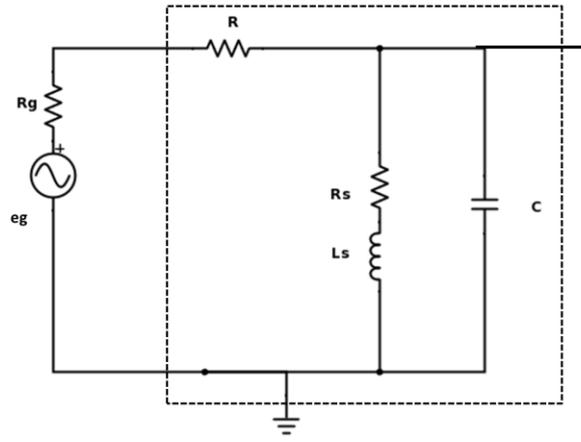
Figura 6 - Circuito RLC com perdas no indutor.
