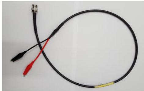
**Figura 2** – Cabo coaxial com terminais BNC - jacarés.
