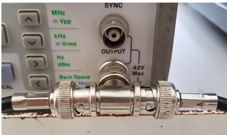
Exemplo de derivação do sinal da saída de um gerador de funções utilizando-se o adaptador tipo T
