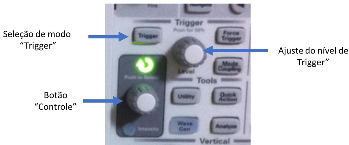
**Figura 13** – Botões para seleção e ajuste do Trigger
