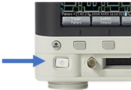
**Figura 5** – Botão para **ligar** ou **desligar** o osciloscópio.
