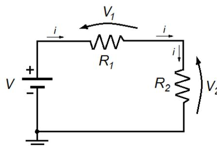
**Figura 4** – Divisor de tensão de resistores.
