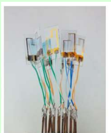
Foto de um conjunto de eletrodos de ouro, que compõe uma língua eletrônica, recoberto com filmes ultrafinos (Imagem: Osvaldo Novais)
