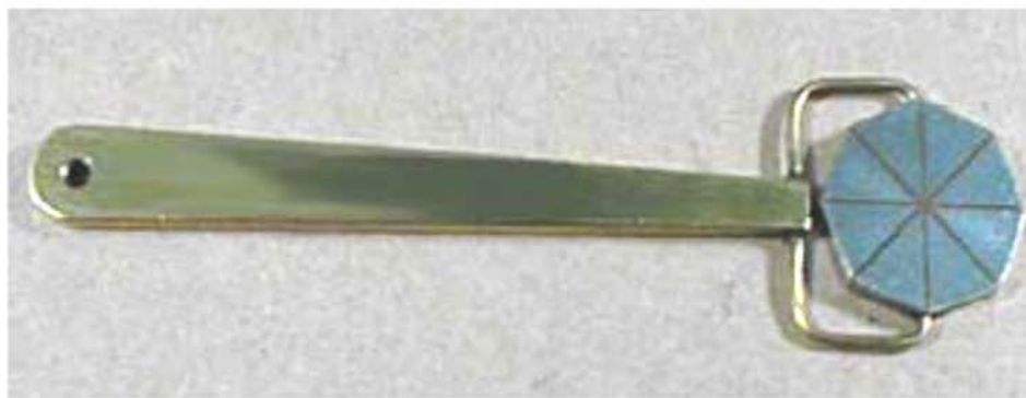
Padrão indicativo de Campo Magnético recomendado pelo Código ASME Sec.V Art.7 , ASTM E-709 e ASTM - E 1444
