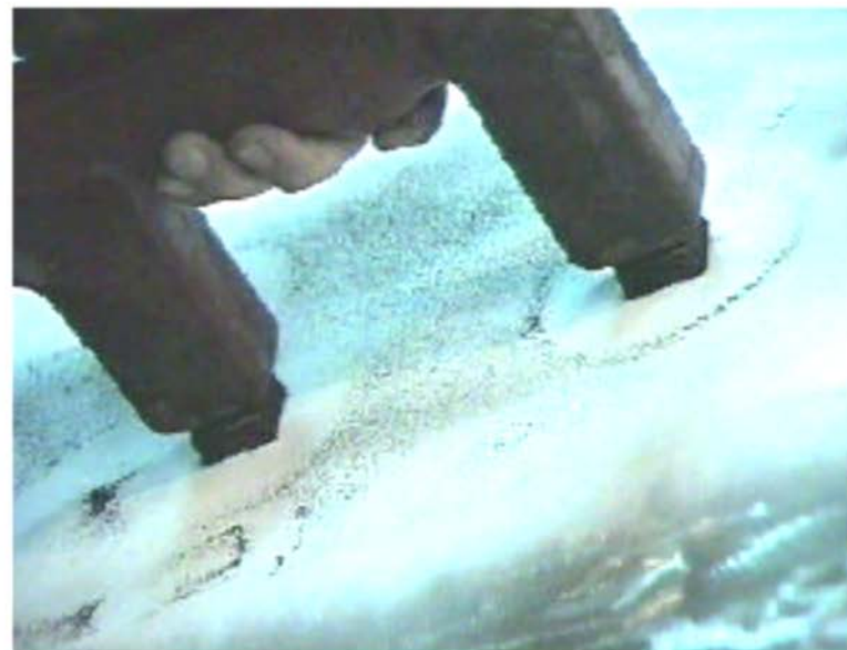
Magnetização utilizando o YOKE
