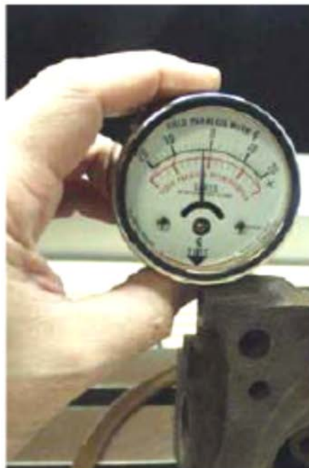
Aparelhos para avaliação do campo magnético residual. Gaussímetro (da esquerda) e o Medidor de Campo ( da direita)
