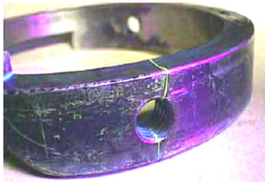
Indicações de trincas produzidas por partículas magnéticas fluorescentes
