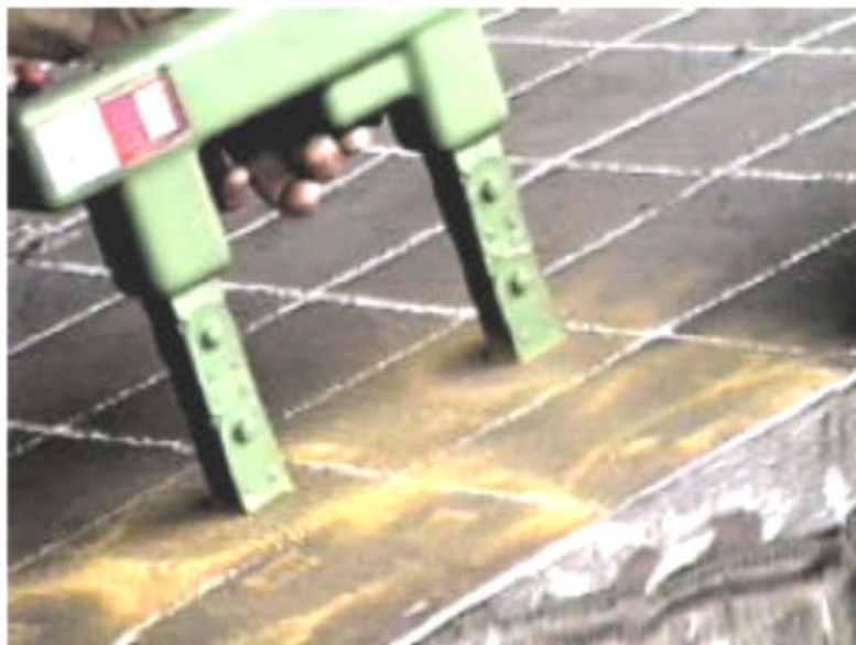
Magnetização utilizando o YOKE
