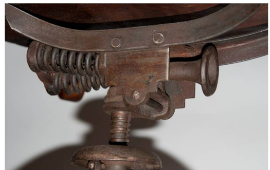
Figura 3 – Poltrona com encosto alto em que se vê no detalhe o mecanismo para balançar e girar. Tais cadeiras foram lançadas no final do século XIX e estiveram em uso até os anos de 1940. Acervo do Museu Paulista da Universidade de São Paulo.
