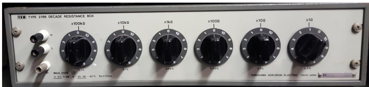
Figura 2: Painel de caixa de resistências utilizada no laboratório.
