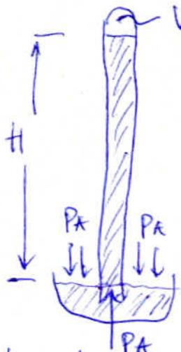
No pequeno volume na extremidade superior do tubo, onde prende de pelo líquido, agora não há nada (vácuo - na verdade, há um pouco de vapor do líquido). Escolhendo-se líquido com baixa pressão de vapor, como o mercúrio, esse resíduo é desprecível).
