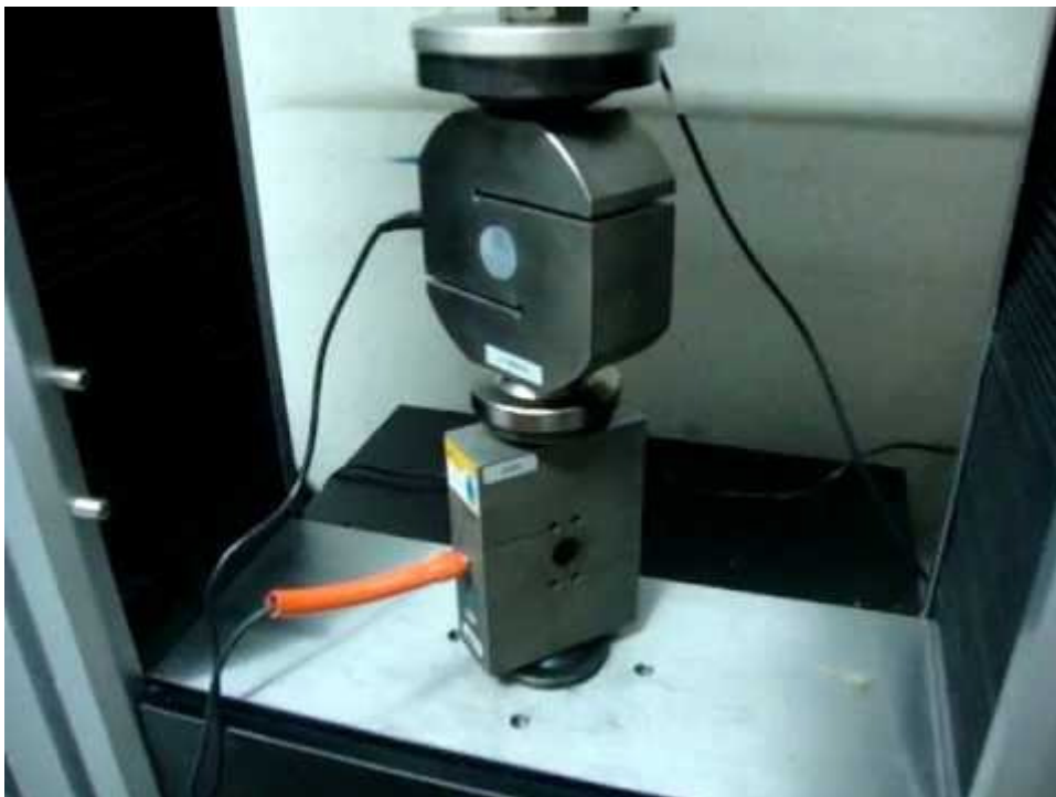
FIGURA 1 – Calibração de célula de carga tipo "S".
