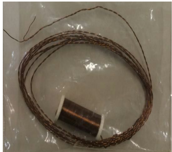
À esquerda, diagrama mostrando o posicionamento das bobinas na câmara, onde os círculos brancos representam as bobinas. E a direita foto de uma bobina de Mirnov
