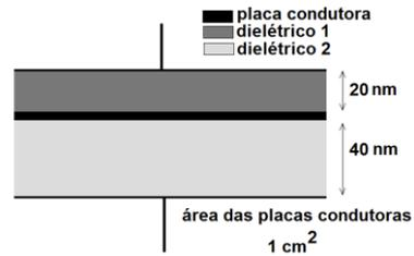
O dispositivo ao lado é um capacitor esquematizado. Ele foi montado com dois dielétricos, um de titanato de estrôncio (de cte dielétrica  $k_1=310$ ) e o segundo, de óxido de titânio (de cte dielétrica  $k_2=110$ ). a) (2,0) Calcule a capacitância resultante do dispositivo. b) (1,0) Mostre um arranjo de dois capacitores que represente este dispositivo.
