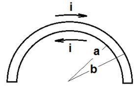
2. Determine o campo  $B$  no pto do arranjo da fig. ao lado.
