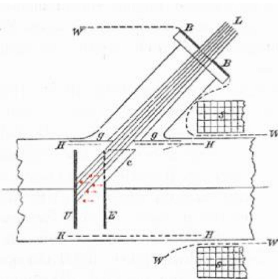
No experimento mede a corrente gerada entre os eletrodos e a energia cinética dos elétrons (recém descobertos - 1897)
