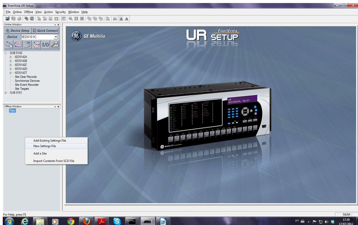
Fig. 4.1: Criando um arquivo offline para armazenar as configurações do IED.
