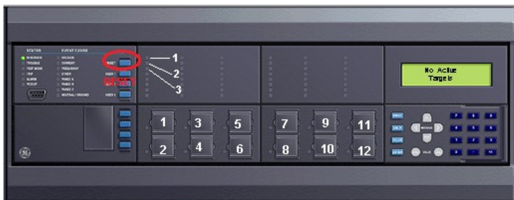
Figura 7.1 - Localização dos botões frontais, LED's e do botão RESET.
