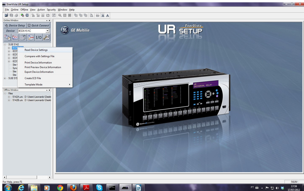
Fig. 6.1: Fazendo a leitura das configurações de um IED presente na rede para um arquivo offline ".urs".
