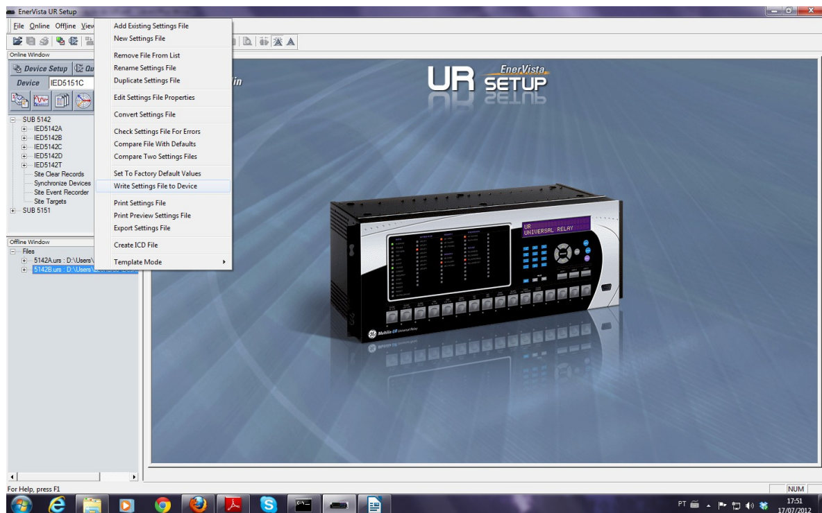
Fig. 5.1: Transferindo as configurações de um arquivo offline no computador para a memória de um IED de campo.
