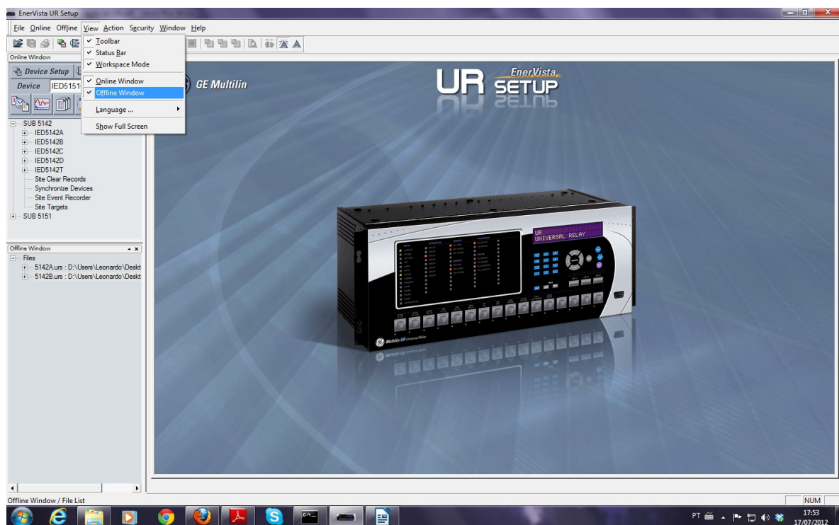
Fig. 2.2: Configurando a exibição da janela "Offline Window" no Enervista.
