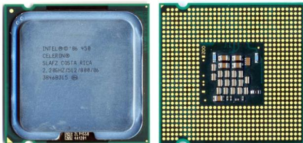
Figura 1. Processador Celeron E1500 de 37,5mm x 37,5mm: (a) vista superior (b) vista inferior.
