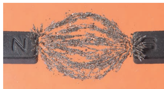
Figura 14 – Campo magnético de dois ímãs com polos diferentes utilizando limalha de ferro.
