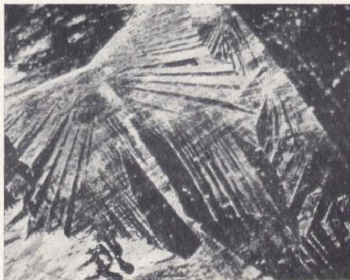
8 - 12. Fotografia (aumento de 6,5 X) de uma peça de zinco. O grupo de cristais em forma de leque destaca-se claramente porque, devido à rugosidade natural do espécime, ele está num plano ligeiramente acima ao do resto do material. A forma cristalina básica não é evidente nas regiões mais escuras, porque elas estão em planos diferentes. Esta é apenas uma possível ilustração do fato de que os metais se apresentam como cristais.
