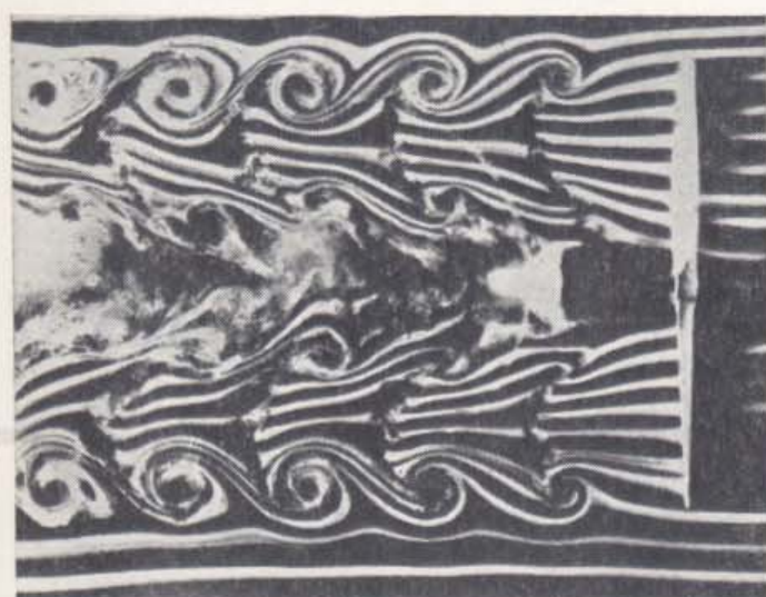
6 - 34. (Acima) O movimento comunicado às partículas do ar por uma bola que gira rapidamente, tal como é lançada por um "pitcher" por exemplo, é uma mostra de um movimento muito complexo. (Abaixo) Redemoinhos formados atrás de uma hélice que gira a 4080 r.p.m. Este é um outro exemplo de movimento extremamente complexo (Fotos por cortesia: F. N. M. Brown).
