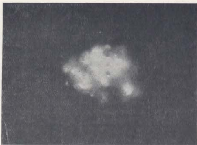
1 — 4(b). A exposição resultante, como a aqui reproduzida, somente poderia provir de alguma emanção invisível, porém penetrante, do sal, desde que não foi permitido que a luz atingisse a chapa fotográfica. Eis aí um exemplo de um recurso simples usado para obter um importante resultado básico.
