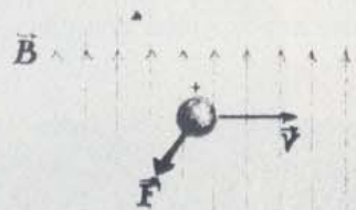
(b) Existe uma força \vec{F} , como a que se mostra, proporcional q , v e B .
