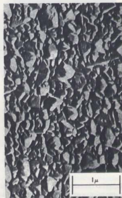
Superfície de um vidro vista através de um microscópio electrónico. A superfície é uma folha de alumínio com três micron de espessura. A amplificação aqui é de aproximadamente 26 000. ( \mu é o símbolo que representa o micron e 1 \mu = 10^{-6} \text{m} .)
