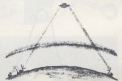
Os satélites são usados para retransmitir micro-ondas por todo o mundo. As micro-ondas podem levar informação radiofónica ou televisiva.
