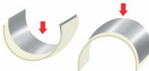
Figura 9 – Montagem dos espelhos esféricos caseiros: pote de sorvete cortado ao meio.
