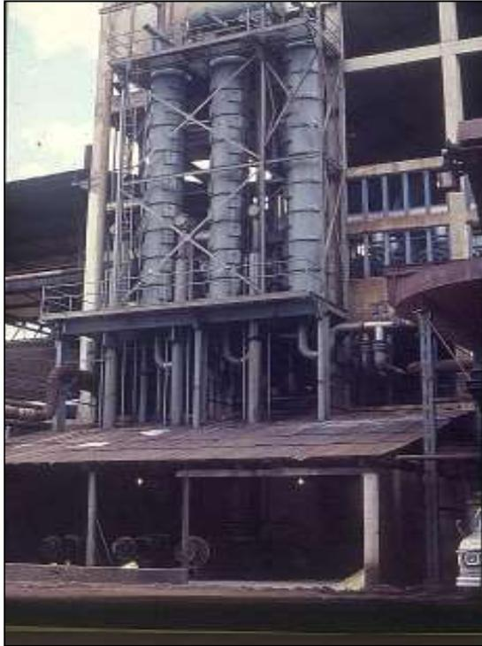
a) coluna de sulfitação
