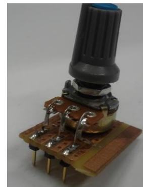
**Figura 02** – Potenciômetro de 10 k $\Omega$  adaptado para o experimento.
