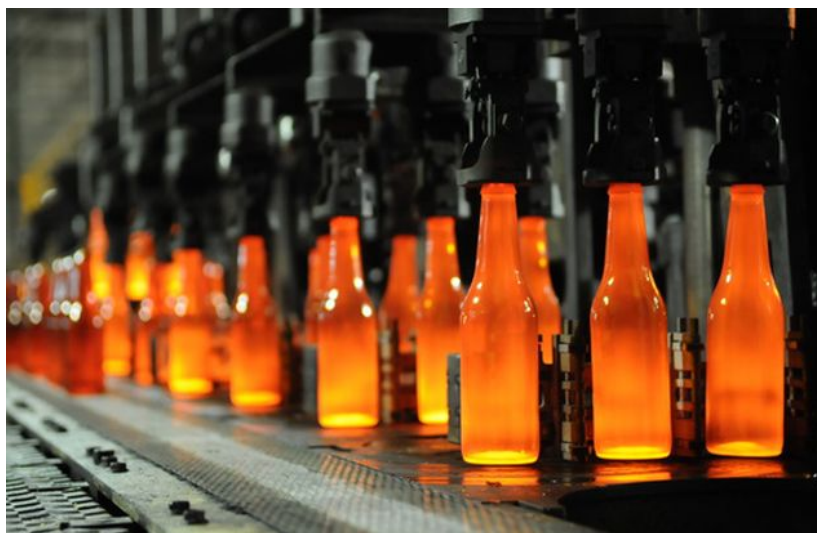
Figura 2.: Garrafas produzidas por sopro. Retirada de Indústria Hoje ( http://www.industriahoje.com.br/como-e-fabricado-o-vidro )
