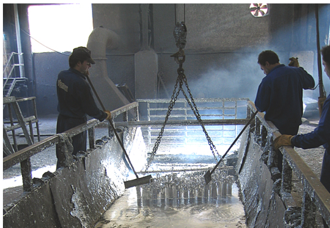
Figura 4 - Linha de produção de galvanoplastia (Fonte: Soluções industriais - Galvanath 3 )
