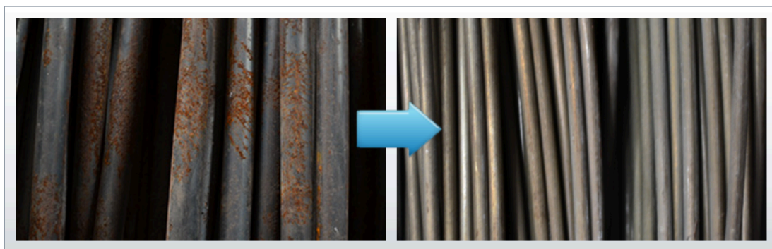
Figura 3 -Antes e depois, processo de decapagem (Fonte: Tref Steel - Decapagem 2 )
